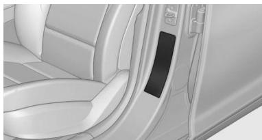
مقادیر فشار باد تایر را همچنین می‌توان روی برجسب فشار هوای تایر که داخل خودرو و روی سوتون در رانتده قرار دارد مشاهده کرد. اطلاعات مربوط به فشار باد تایرها، براساس سایز تایرهایی که به نظر سازنده خودرو برای خودروی شما مناسب است درج شده است در صورتی که حرف مشخصه سرعت تایر در دسترس نباشد مقدار فشار بار را براساس سایز تایر تنظیم کنید.
