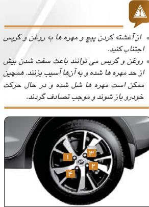
خودرو را پایین آورده و جک را از زیر آن خارج کنید. مهره ها را بطور ضربه‌ری مطابق با ترتیب نشان داده شده در شکل دو تا سه مرتبه با گشتاور سفت بیندید. جک را پایین بیاورید تا جایی که چرخ به آرامی روی زمین قرار گیرد. سپس مهره ها را با آچار چرخ به طور ضربه‌ری سفت کنید.
