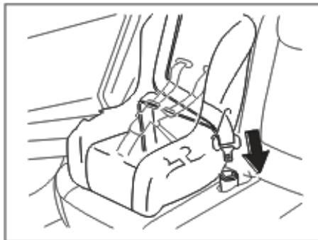
۱. مطابق دستورالعمل کارخانه سازنده، کمریندایمنی را ز داخل باروی صندلی کودک عبوردهید؛ زبانه رادر قفل جا زده و از قفل شدن و پیچ نداشتن تسمه اطمینان حاصل نمایید، بخش روی پای تسمه را سفت کنید.
