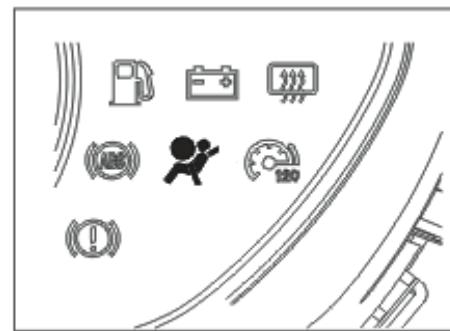
زمانی که سوئیچ در وضعیت روشن "ON" قرار دارد، برای چراغ هشدار SRS روشن شده و پس از حدود ۵ ثانیه اطلاع از محل قرارگیری هر کدام از این قطعات به خاموش می‌شود که بیانگر عملکرد صحیح سیستم تصویر فوق مراجعه نمایید:
