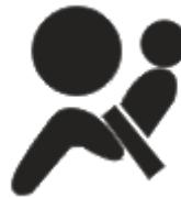
در صورتی که سیستم ایربگ/پیش کشنده کمربند اینمی در شرایط سالم قرار داشته باشند، پس از قرار دادن سوئیچ در وضعیت روشن "ON"، یا پس از استارت موتور، این چراغ هشدار روشن شده و پس از ۶ ثانیه خاموش می‌شود.
