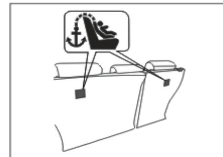
در صورتی که صندلی ایمنی کودک دارای تسمه اتصال بالایی می‌باشد، باید تسمه اتصال بالایی را به قلاب نگهدارنده در پشت پشتی صندلی‌های عقب (مطابق تصویر) سوار کنید. برای اطلاع از جزئیات بیشتر، دستورالعمل همراه صندلی را مطالعه نمایید.
