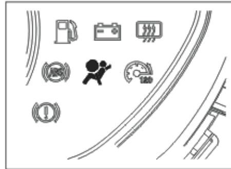
چراغ هشدار سیستم پیش کشنده کمربند اینمی جلو برای آگاه ساختن راننده از وجود مشکلی در سیستم تعییه شده است. در صورت بروز هر کدام از شرایط زیر، سیستم ایربگ یا پیش کشنده‌ها به طور غیرعادی عمل می‌کنند. در اولین فرصت ممکن برای تعمیر خودرو به نمایندگی‌های مجاز شرکت کرمان موتور مراجعه نمایید.
