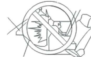
صندلی کودک را به عقب را فقط در صندلی های عقب نصب کنید. در صورت نصب صندلی کودک رو به عقب بر روی صندلی سرنشین جلو، ایربگ نیروی شدیدی باز شده، به شدت به صندلی ضربه زده و آن را به عقب حرکت می دهد که منجر به صدمات جسمی جدی یا حتی مرگ کودک می گردد. هرگز حین قرار داشتن کلید روشن / خاموش ایربگ سرنشین جلو در وضعیت روشن، صندلی کودک رو به عقب را بر روی صندلی سرنشین جلو نصب نکنید.
