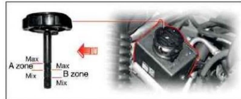
پس از توقف خودرو در سطحی هموار و خلموش کردن موتور، می توانید سطح روغن هیدرولیک فرمان را بررسی کنید. سطح روغن باید بین علامت MAX و MIN واقع بر روی گیج متصل به درپوش مخزن باشد. در صورتی که سطح روغن به علامت MIN رسیده و یا از این علامت پایین تر آمده باشد، باید مقداری از روغن یا مشخصات درج شده در جدول را درون مخزن بریزید. تفاوت بین علامت های MAX و MIN توسط سطح روغن در هنگام سرد و داغ بودن روغن را نشان می دهد.
