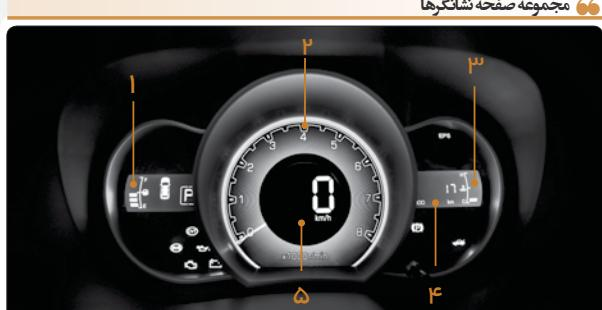
۱. نشانگر سوخت، ۲. دورسنج، ۳. نشانگر دمای مایع خنک کننده، ۴. نمایشگر چندمنظوره، ۵. سرعت سنج
