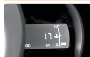
با قرار گرفتن سوییچ در وضعیت ON، این نشانگر دمای مایع خنک کننده موتور را نمایش می‌دهد. از علامت C (سرد) تا H (داغ) (رش) نشانگر به شش درجه تقسیم شده. هنگامی که دمای کلیومتر شمار کل مسافتی که خودرو طی کرده را نمایش می‌دهد، با فشار دادن لحظه‌ای دکمه کلیومتر شمار، می‌توانید انتخاب کنید کام یک از این پنج گزینه نمایش داده شود.
