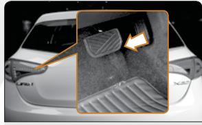
با شمار پدال ترمز، چراغ‌های ترمز از جمله چراغ سوم ترمز روشن می‌شوند. با رها کردن پدال ترمز، این چراغ‌ها خاموش می‌شوند.
