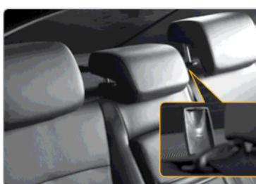
۱. برای باز کردن در پوش قلاب نگهدارنده صندلی کودک آن را به سمت بالا بکشید و تسمه تنظیم و نگهدارنده صندلی کودک را در قلاب نگهدارنده LATCH متصل نمایید و از مکرم بسته شدن آن مطمئن شوید.
