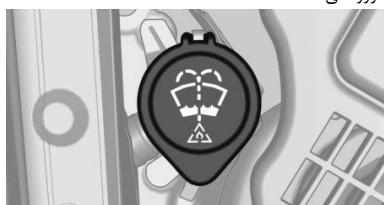
مخزن مایع شست و شو در محفظه موتور قرار دارد.
