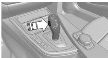
2. وقتی کمربند ایمنی راننده بسته است، اهرم دنده را آرام درجه منظر فشار دهید و بر نقطه مقاومت غلبه کنید. اهرم دنده هنگام آزاد شدن به موقعیت اصلی بر می‌گردد.
