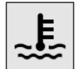
این چراغ در حالتی که درجه حرارت سیال خنک‌کننده موتور به میزان قابل توجهی افزایش می‌یابد، به رنگ قرمز در می‌آید.
