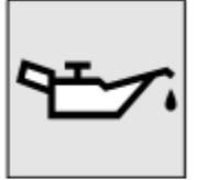
این چراغ هنگامی که سویچ استارت روی " ON " و یا وضعیت عملکرد در حالت ON است روشن شده و پس از استارت زدن موتور، چراغ خاموش می شود. اگر پس از روشن شدن موتور نیز روشن ماند، فشار روغن موتور خیلی پایین است. موتور را خاموش نموده و آن را بازبینی نمایید.
