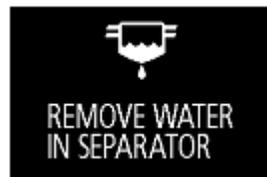
هنگامی که کلید استارت بر روی "ON" و یا وضعیت عملکرد در حالت ON قرار دارد، اگر بیشتر از حد مشخص آب در فیلتر سوخت تجمع یابد نشانگر هشدار در صفحه نمایشگر چندگانه نمایش داده می شود.
