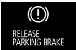
این هشدار اگر با ترمز دستی کشیده شده رانندگی کنید نمایش داده می شود. چراغ هشدار تنها در صفحه ابزار هنگامی که ترمز دستی کشیده شده است نمایش داده می شود.
