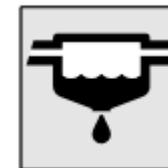
هنگامی که سویچ استارت در حالت "ON" یا وضعیت عملکردی در حالت ON است، اگر بیش از حد مجاز آب درون فیلتر سوخت جمع شده باشد چراغ روشن خواهد شد.
