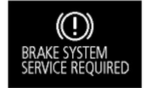
هنگامی که کلید استارت بر روی "ON" است یا وضعیت عملکرد در حالت ON باشد. اگر سیال ترمز "پایین" باشد این هشدار نمایش داده می شود.
