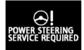
اگر ایرادی در سیستم فرمان برقی بوجود آید نشانگر هشدار آن در صفحه نمایشگر اطلاعات چندگانه روشن خواهد شد. در حالت عادی وقتی سویچ استاتر در وضعیت ON قرار گیرد چراغ هشدار برای لحظاتی روشن شده و خاموش می شود.
