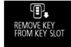
چنانچه وضعیت کلید خاموش/روشن موتور در حالت OFF و سوئیچ هوشمند در محل قرار گیری سوئیچ هوشمند باشد، اگر در این وضعیت درب سمت راننده باز شود، هشدار در صفحه نمایش نمایان می‌شود و بازر (بوق هشدار) برای ۳ ثانیه به صدا در می‌آید تا سوئیچ را بردارید.
