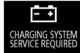
اگر مشکلی در سیستم شارژ وجود داشته باشد، نمایشگر هشدار در صفحه اعلان نمایشگر چند اعلانی نمایش داده می شود. همچنین یک چراغ هشدار در صفحه ابزار روشن می شود.
