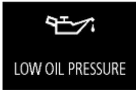
اگر فشار روغن موتور، در حالی که موتور روشن است پایین برود، نمایشگر هشدار بر روی صفحه اعلان نمایشگر چند اعلانی نمایش داده می شود.
