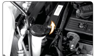
مخزن مایع شیشه‌شوی را بررسی کنید. اگر مایع شیشه‌شوی داخل مخزن کافی نیست، به میزان لازم اضافه نمایید.
