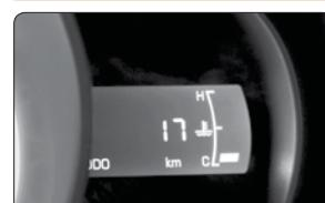
با قرار گرفتن سوییچ در وضعیت ON، این نشانگر دمای مایع خنک کننده موتور را نمایش می‌دهد. از علامت C (سرد) تا H (داغ) نشانگر به شش درجه تقسیم شده. هنگامی که دمای کلیومتر شمار کل مسافتی که خودرو طی کرده را نمایش می‌دهد، با فشار دادن لحظه‌ای دکمه کلیومتر شمار، می‌توانید انتخاب کنید کام یک از این پنج گزینه نمایش داده شود.
