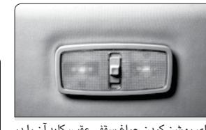
برای روشن کردن چراغ سقفی عقب، کلید آن را در وضعیت ON و برای خاموش کردن چراغ، کلید را در وضعیت OFF قرار دهد. همچنین در صورت قرار دادن کلید در وضعیت DOOR، باز شدن هر یک از دربهای چراغ سقفی عقب روشن می شود. با بسته شدن تمام دربها، چراغ خاموش می گردد.
