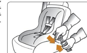
سر آزاد کربنید را کنیده و روی کمر ممکن کنید و همزمان صنعتی کوبک را به سمت پشتی و شنیدنگاه صنعتی پفتارید تا در جای خود ممکن شود. پس از نصب صنعتی درجهات مختلف به آن نیرو وارد نیرو وارد کنید و از ممکن بسته شدن آن اطمینان حاصل نمایید.
