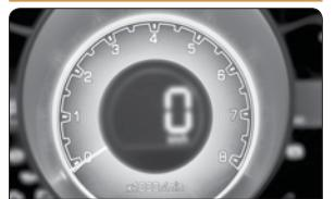
دور سنج دور موتور لحظه‌ای را بر حسب rpm (دور بر دقیقه) نمایش می‌دهد. دور موتور می‌تواند از صفر
