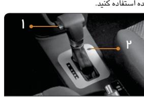
۱. دکمه تعویض دنده هنگام استارت زدن دکمه را نگه دارید. در زمان تعویض دنده از P به N. R به R و R به P دنده از P به R ابتدا پایدال ترمه را فشار داده و سپس این دکمه را نگه دارید.
