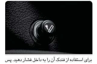
برای استفاده از فندک آن را به داخل فشار دهد. پس از داغ شدن، فندک بیرون می‌پرسد. در صورت خاموش
