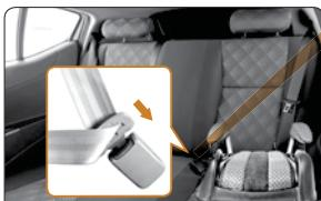
طبقاً با سنتورالعمل شرکت سازنده صنعتی مخصوص نوجوان کربنید اینست با سه نقطه اتکارا از میان صنعتی یا بیرامون آن عبور نماید، زبانه کربنید را درون قفل آن جا بزنید. از پیچاندن تسمه کربنید اجتناب کرده و تا جای ممکن آن را ممکن کنید.
