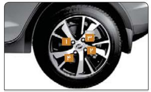
خودرو را پایین آورده و جک را از زیر آن خارج کنید. مهره ها را بطور ضربه‌ری مطابق با ترتیب نشان داده شده در شکل دو تا سه مرتبه با گشتاور سفت بیندید. جک را پایین بیاورید تا جایی که چرخ به آرامی روی زمین قرار گیرد. سیس مهره ها را با آچار چرخ به طور ضربه‌ری سفت کنید.
