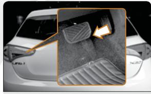
با شمار پدال ترمز، چراغ‌های ترمز از جمله چراغ سوم ترمز روشن می‌شوند. با رها کردن پدال ترمز، این چراغ‌ها خاموش می‌شوند.
