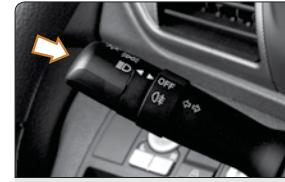
تنظیم ارتفاع شعاع نور چراغ‌های ترکیبی جلو: با چرخاندن کلید تنظیم ارتفاع نور چراغ‌های جلو، زاویه تابش نور چراغ را کنترل کنید. این کلید در چهار وضعیت صفر، ۱، ۲ و ۳ قابل تنظیم است.
