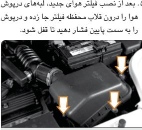
۴. اگر المنت فیلتر هوای بیش از حد کثیف است با کپرسور هوای پشت آن بدمید تا مواد زائد و
