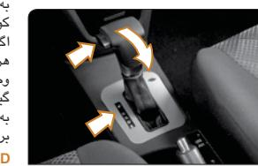
۱. دنده پارک: پس از توقف کامل، دسته دنده به دنده عقب، قرار داده و ترمه دسته را درگیر کنید تا خودرو حرکت نکند. به هنگام استارت موتور، دسته دنده باید در وضعیت P باشد. در غیر این صورت موتور روشن نمی‌شود.
