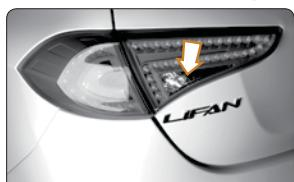
هنگامی که سوییچ خودرو در وضعیت ON قرار دارد، با قرار دادن دسته دندنه در دندنه عقب، این
