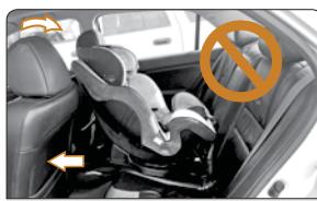
تصویر باید به رسیله کمربند اینمنی با سه نقطه اتکاری روی صندلی نصب شوند. نصب صندلی باید مطابق با استورالعمل شرکت سازنده انجام گیرد.
