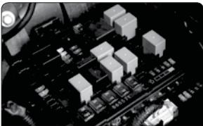
کار نکردن هر یک از اجزای الکتریکی خودرو ممکن است به علت سوختن فیوزها باشد. در این صورت باید جعبه فیوز را بررسی کرده و فیوز سوخته را تعویض نمایید. در هنگام تعویض فیوز، سوییچ باید در وضعیت LOCK قرار داشته باشد.
