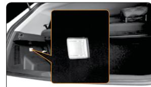
این چراغها باز شدن درب صندوق عقب روشن شدند و به مخصوص سنت شدن تمام درب صندوق، خاموش می شوند.
