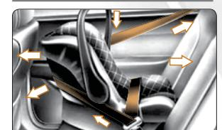
به هنگام جا زدن زبانه کربنید در قفل، صنعتی محافظت را بامان توان به پشتی و شنیدنگاه صنعتی بفتارید تا خوب در جای خود ممکن شود. پس از نصب صنعتی درجهات مختلف به آن نیرو وارد کنید و از ممکن بسته شدن آن اطمینان حاصل نمایید.
