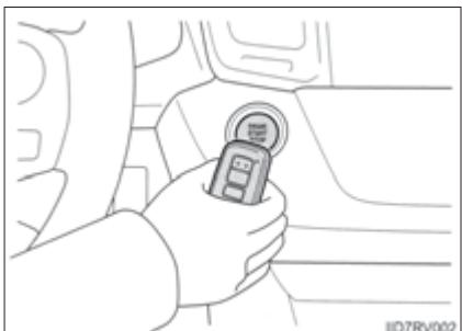
را لمس کنید. حین شناسایی سوئیچ الکترونیکی، آژیر به صدا در آمده و سوئیچ موتور در حالت "IGNITION ON" قرار می‌گیرد.
