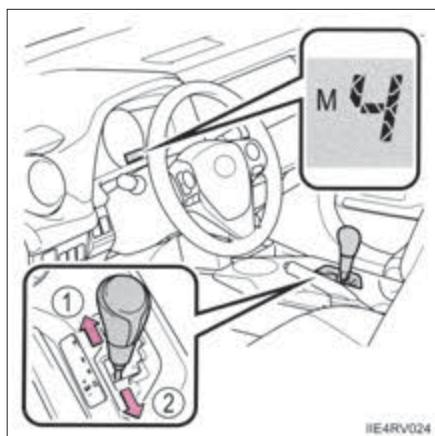
با این وجود، حتی زمانی که دنده در موقعیت M قرار داشته باشد، اگر دور موتور خیلی بالا یا پایین برود، دنده به طور اتوماتیک تغییر می‌کند.
