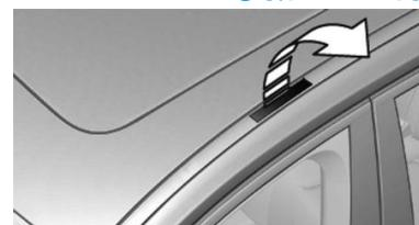
قلاب بارینده در محل چفت آن روی سقف خودرو در قسمت بالای درها قرار دارد.
