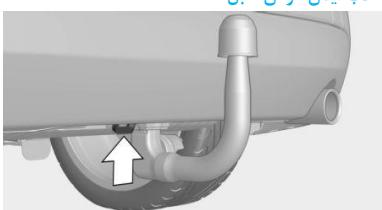
جهت اتصال ایمن کابل، روی گیره اتصال یک قلاب وجود دارد.
