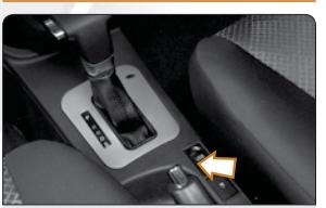
کنسول به یک ورودی USB و یک ورودی AUX مجهز است.
