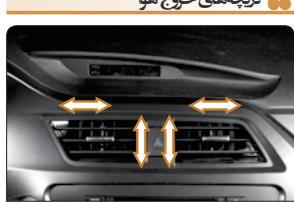
با استفاده اهرم روی دریچه ها، جهت وزش را تنظیم کنید.
