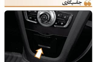
برای استفاده از فندک آن را به داخل فشار دهید. پس از داغ شدن، فندک بروز نمی‌پرسد. در صورت خاموش
