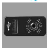
یک دستگاه صوتی خارجی مانند MP3 پلیر می تواند با پورت IN رابط USB صوتی در جادستی میانی، متصل شود.
