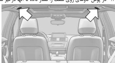
۳. هر دو پین بالایی توري نگهدارنده بار را به گيره‌ها داخل کنید تا جایی که متوقف شود، فلاش ۱، و به سمت جلو فشار دهید.
