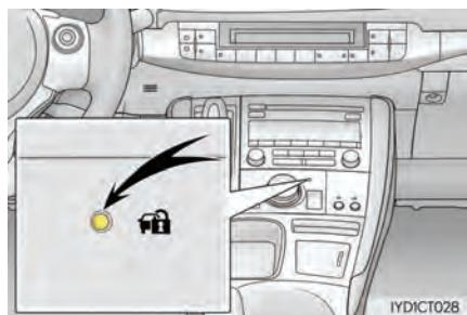
درب‌ها و درب موتور را بسته و تمامی درب‌ها را با استفاده از عملکرد ورود یا فرستنده کنترل از راه دور قفل نمایید. سیستم پس از ۳۰ ثانیه به طور اتوماتیک فعال می‌شود.
