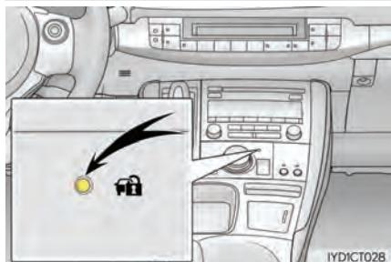
پس از خاموش کردن سوئیچ موتور، چراغ نشانگر چشمک پزده، نشان می‌دهد سیستم در حال کار کردن است.
