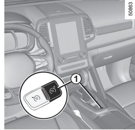
عملکرد محدودکننده سرعت به شما کمک می‌کند تا در سرعتی که برای محدودکننده سرعت انتخاب کرده‌اید، ثابت بمانید.
