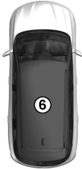
در صورتی که حین روشن بودن موتور، درب باز و قفل شود و کارت در منطقه 6 قرار نداشته باشد، پیغام عدم شناسایی کارت نشانگر این است که کارت درون خودرو نیست. برای مثال: این مورد برای جلوگیری از دور شدن فردی که کارت را همراه دارد استفاده می‌شود.
