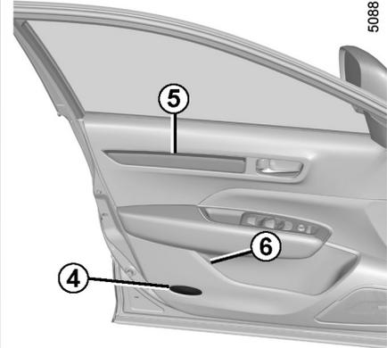
چراغ‌های روی درب جلو 4، چراغ روشنایی محیط 5، چراغ محفظه نگهدارنده روی درب 6 با نمایندگی‌های مجاز مشورت نمایید.
