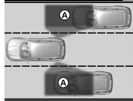
این سیستم وجود سایر خودروها در محدوده **A** را به راننده هشدار می‌دهد. هنگامی که سرعت خودرو بین حدود ۳۰km/h (۱۹mph) و ۱۴۰km/h (۸۷mph) است سیستم فعال می‌شود. این عملکرد از سنسورهای 1 که جلو و پشت هر دو طرف سپر نصب شده است، استفاده می‌کند.
