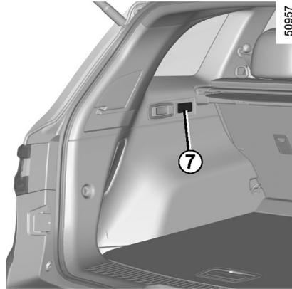
چراغ‌های محفظه بار 7 چراغ 7 را با فشار دادن زبانه روی هر سمت باز کنید (با استفاده از پیچ‌گوشی سرتخت). چراغ را جدا نمایید. زبانه 8 را برای آزاد کردن قاب 10 و دسترسی به لامپ 9 فشار دهید. نوع لامپ: W5W.
