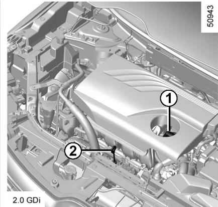
به منظور جلوگیری از سرریز شدن، توصیه می‌شود که هنگام پر یا اضافه کردن مخزن، از قیف استفاده نمایید.
