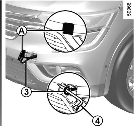
تنها از قلاب یدک کشی جلو **A** و قلاب یدک کشی عقب **5** برای بکسل کردن استفاده نمایید (از پولس‌ها یا دیگر قسمت‌های خودرو استفاده نکنید). از این نقاط تنها برای بکسل کردن استفاده شوند: از این نقاط برای بلند کردن مستقیم یا غیره مستقیم استفاده نکنید.
