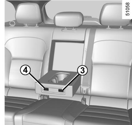
بسته به مدل خودرو، در صورتی که زیرآرنجی صندلی‌های عقب پایین آمده است، کنترلگر گرمکن صندلی‌های عقب در زیرآرنجی عقب قرار دارد.
