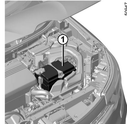
باتری 1 نیاز به هیچ‌گونه تعمیر و نگهداری ندارد. نباید آن را باز کنید یا هرگونه مایعی به آن اضافه نمایید.
