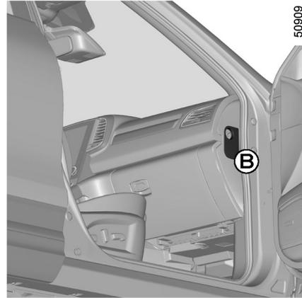
فیوز داخل اتاق سرنشین B در خودروهای دارای عملکرد توقف و حرکت روکش B را با استفاده از پیچ‌گوشتی یا چیزی مشابه آن باز کنید.
