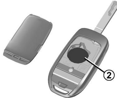
توجه: هنگام تعویض باتری، از تماس با مدارهای الکتریکی در روکش کلید خودداری نمایید.
