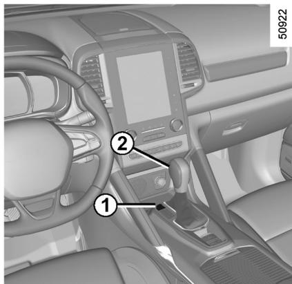
حین غیرفعال بودن تنظیمات، هنگامی که دسته دنده در موقعیت **P** قفل شده است و با فشار دادن پدال ترمز آزاد نمی‌شود، می‌توانید آن را به صورت دستی آزاد نمایید. برای انجام این کار، یک میله سفت را در سوراخ **1** وارد نمایید، میله را فشار داده و دکمه **2** واقع روی اهرم تعویض دنده را به‌طور همزمان فشار دهید.
