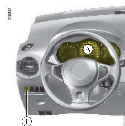
صفحه نمایشگر A به هنگام باز شدن سوئیچ روشن می شود.
