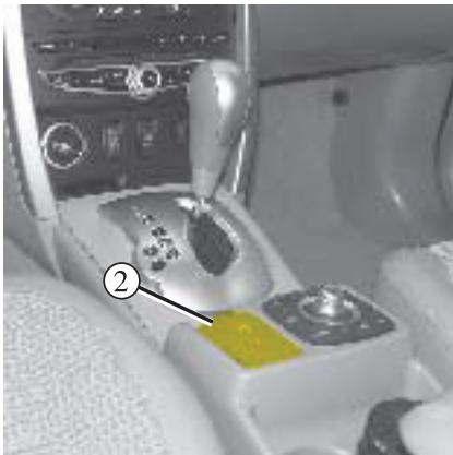
لامپ نشانگر به همراه پیغام "check parking brake" روشن می شود. به هنگام باز بودن سویچ، پدال ترمذ را کلید ۲ را به طور همزمان فشار دهید. در صورتیکه خاموش نشدن، با خودرو رانندگی ننموده و با نمایندگی مجاز تماس بگیرید.
