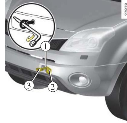
برای یدک کشیدن خودرو فقط از قسمت جلو شماره ۱ یا قسمت شماره ۴ استفاده کنید. (هرگز از پلاوس های خودرو برای این کار استفاده نکنید). این قسمت ها فقط برای یدک کشیدن استفاده می شوند. هیچ گاه از این نقاط برای بلند کردن خودرو به طور مستقیم یا غیر مستقیم استفاده نکنید.
