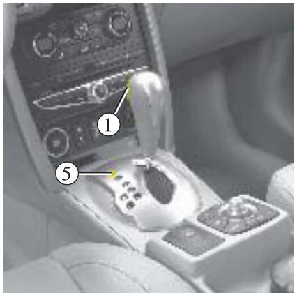
در هنگام خاموش بودن موتور، اگر اهرم تعویض دندۀ در حالت P قفل شده باشد و حتی با فشار دادن پدال ترمز آزاد شود، می توان آن را به صورت دستی آزاد نمود، برای این کار روکش ۵ در محل پایه اهرم تعویض دندۀ را باز کنید. سپس به طور همزمان
