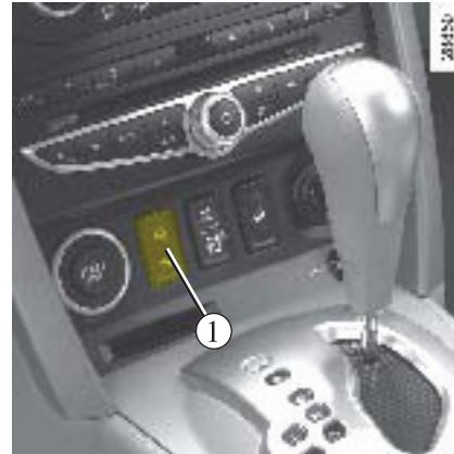
کروز کنترل به شما امکان نگهداری خودرو در یک سرعت انتخاب شده توسط شما را می دهد. که سرعت کنترل شده نامیده می شود. این سرعت کنترل شده می تواند در سرعت بالای 30Km/h تنظیم شود.
