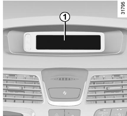
هنگامی که سوئیچ در موقعیت روشن (ON) قرار دارد، زمان و بسته به مدل خودرو، دمای بیرون در نمایشگر 1 نمایش داده می شود.
