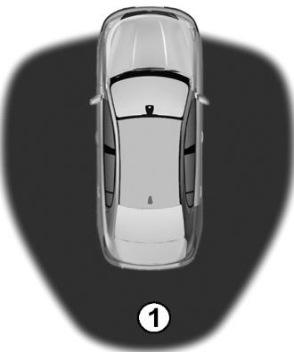
دسترسی به محدوده ۱، محدوده‌ای که خودرو قفل است، به محیط اطراف بستگی دارد. هنگامی که کارت رنو را به همراه خود دارید از فشار ندادن تصادفی دکمه‌ها که باعث قفل / باز شدن درب‌ها می‌شود، اطمینان حاصل نمایید.
