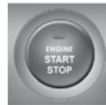
با گیربکس دستی برای خاموش نمودن موتور (وضعیت START/RUN) و یا باز بودن سوئیچ خودرو، خودرو را متوقف نموده و سپس کلید روشن/خاموش موتور را فشار دهید.
