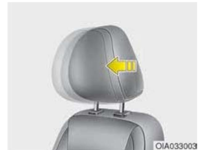
تنظیم گردنی (پشت سری) به جلو و عقب بخش گردنی (پشت سری) می‌تواند در سه وضعیت مختلف رو به جلو تنظیم شود و بدین منظور باید بخش گردنی (پشت سری) را تا دندانه مطلوب جلو کشید. برای تنظیم بخش گردنی (پشت سری) در دورترین موقعیت عقبی، آن را کاملاً به دورترین نقطه جلو بکشد و سپس آن را رها کنید.
