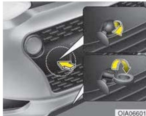
۳. قلاب را با گرداندن در جهت عقربه‌ها در سوراخ مخصوص نصب کنید تا وقتی که کاملاً سفت شود.
