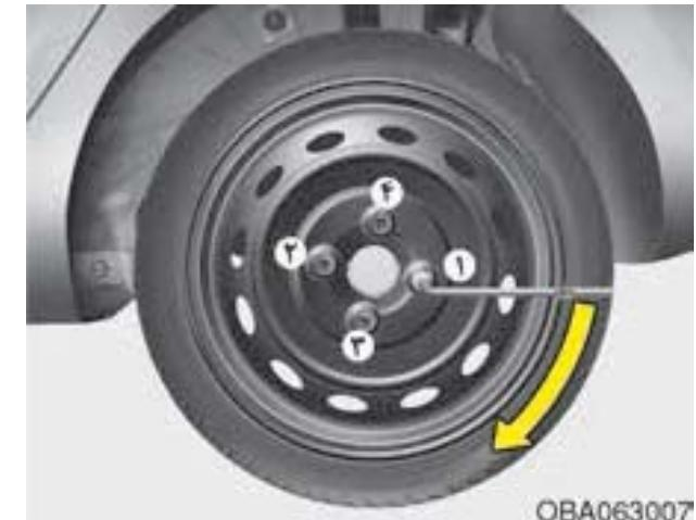
سپس آچار را مانند شكل فوق قرار داده و مهره‌ها را سفت کنيد. مطمئن شويد که آچار کاملاً وارد سرپیچ شده است و از رفتن روی دسته آچار با پا و يا استفاده از لوله برای افزایش دسته آن و سفت کردن بيشتر پيچ خودداری کنيد.
