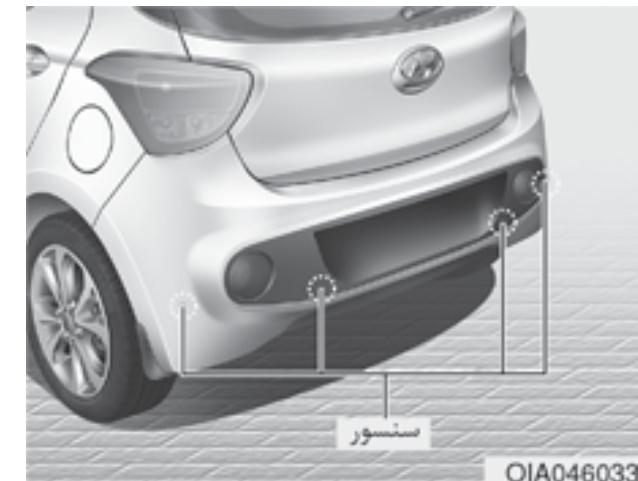
سیستم کمکی دند عقب، در حرکت رو به عقب خودرو به راننده کمک می‌کند و در صورت دیدن هر مانعی در فاصله ۱۲۰ سانتی متری پشت خودرو، خودرو آذیر می‌کشد. این یک سیستم مکمل است که موانع را در بازه و محل سنسورها شناسایی می‌کند اما نمی‌تواند اشیا را در دیگر بخش‌هایی که سنسورها وجود ندارند، شناسایی نماید.
