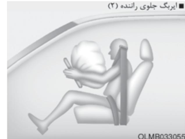
به محض عمل کردن کیسه هوا، درزهای روی تشک پد جلوی راننده روی غربیلک تحت فشار ناشی از باز شدن ایربگ‌ها، باز می‌شوند. باز شدن بیشتر این روکش امکان باد شدن کامل ایربگ‌ها را فراهم می‌نماید.
