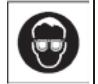
موقع شارژ و یا کار در نزدیکی باتری از عینک محافظ استفاده کنید. همیشه موقع کار در فضای بسته از وجود تهویه مناسب اطمینان حاصل کنید.
