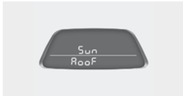
اگر راننده سوئیچ را از روی خودرو بردارد و یا با سوئیچ هوشمند خودرو را خاموش نماید، و درب سمت راننده را موقعی که سان رووف کاملاً بسته نیست باز کند در آن صورت بوق هشدار به صدا در می آید و چراغ هشدار باز بودن سان رووف روشن و یا چشمک می زند.
