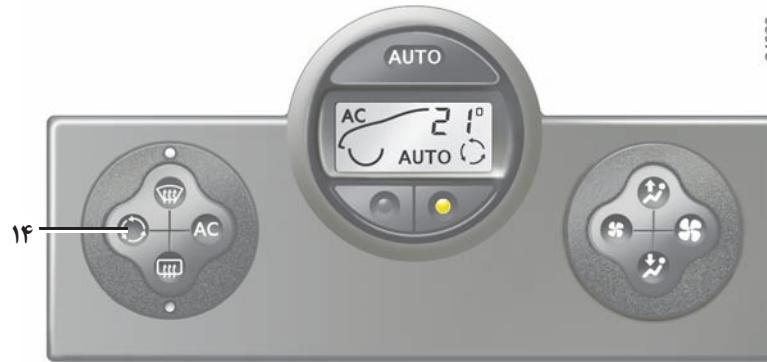
استفاده طولانی در این وضعیت به دلیل عدم تجدید هوا می‌تواند باعث ایجاد بو و تشکیل بخار بر روی شیشه‌ها شود.
