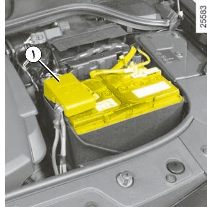
باتری نیاز به سرویس و سر ریز ندارد: هیچ گاه در پوش ۱ را باز نکنید.
