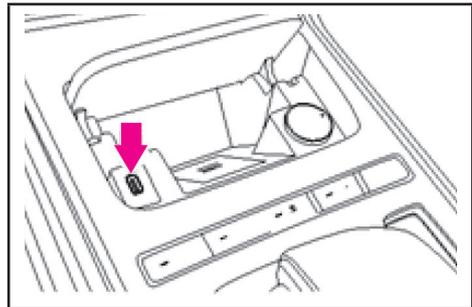
درگاه USB جلو در جلوی دسته دنده قرار دارد که پس از باز کردن درب آن، قابل مشاهده است. درگاه USB جلو به وسیله سیستم مالتی مدیا خواننده
