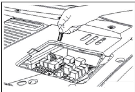
۳. با استفاده از فیوز کش، فیوز سوخته را خارج نمایید.
