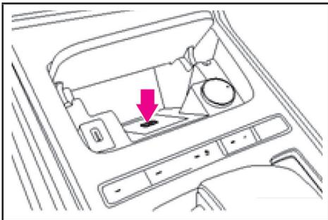
پنل شارژ کردن بی‌سیم تلفن همراه، در داخل محفظه نگهداری در جلوی کنسول وسط قرار دارد.
