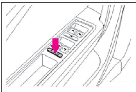
با استفاده از کلید هوشمند یا کلید مرکزی روی پنل کلیدهای درب سمت راننده می‌توانید تمام درب‌های خودرو را قفل یا باز نمایید.
