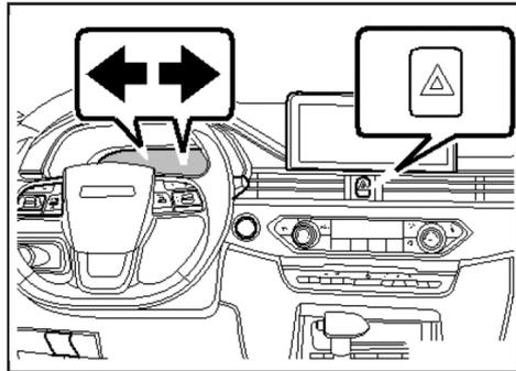
کلید چراغ هشدار خطر (فلاشر) در بالای پنل کنترل سیستم تهویه مطبوع قرار دارد.
