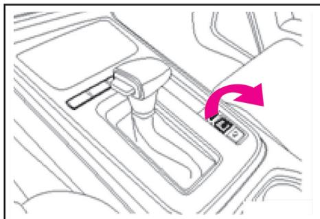
کلید EPB در سمت راست دسته دنده قرار دارد. برای استفاده از عملکرد ترمز پارک برقی، کلید ترمز پارک برقی را به سمت بالا بکشید. به منظور پارک و توقف خودرو، چرخ‌های عقب قفل خواهند شد. پدال ترمز را فشار داده و کلید ترمز پارک برقی را نیز فشار دهید که در این صورت ترمز پارک برقی غیرفعال می‌شود. در این شرایط چرخ‌ها قفل نمی‌باشند و خودرو هم در وضعیت
