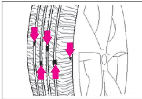
۱. آج تایر را از نظر علامت ساییدگی بررسی نمایید. در صورتی که آج تایر تا حد مجاز، یعنی آج تایر تا حد مشخص شدن علامت ساییدگی تایر ساییده شود، در این شرایط، عملکرد و ایمنی تایر به شدت کاهش یافته و لازم است تا تایر را تعویض نمایید.
