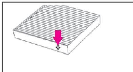
۳. سطح فیلتر را بررسی و تمیز کنید و در صورت لزوم فیلتر را تعویض نمایید.
