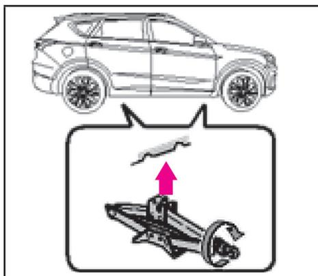
جک را روی سطح هموار به صورت درست قرار دهید و مطمئن شوید جک محکم و به طور صحیح در محل جک زدن خودرو قرار داشته باشد. دسته جک را تا زمانی که سر جک با محل جک زدن روی بدنه خودرو تماس پیدا کند، با دست در جهت حرکت عقربه‌های ساعت بچرخانید.
