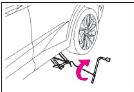
هنگام جک زدن خودرو، ابتدا میله جک را در جک و سپس آچار چرخ را در میله جک محکم نمایید. سپس آچار چرخ را در جهت حرکت عقربه‌های ساعت بچرخانید. هنگام تماس جک با بدنه خودرو و بالا آمدن خودرو، موقعیت جک را بررسی کنید که مناسب باشد.
