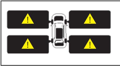
چنانچه فشار باد تایر پایین یا دما بالا باشد، نشانگر نقص عملکرد سیستم روشن شده و فشار باد تایر ممکن است فشار باد نامناسب را نشان می‌دهد. در این شرایط جهت بررسی و تعمیر فوری به نمایندگی مجاز خدمات پس از فروش بهمن مراجعه کرده و با احتیاط رانندگی نمایید.
