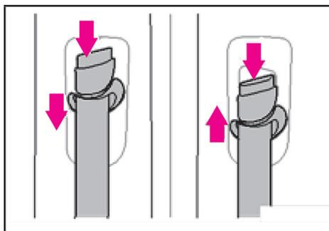
جهت تامین حداکثر راحتی و ایمنی، می‌توانید ارتفاع پایه نگهدارنده تسمه روی شانه را تنظیم کنید. با فشار دادن دکمه به سمت پایین و بالا، ارتفاع را در موقعیت مناسب تنظیم کرده و سپس دکمه را رها کنید.
