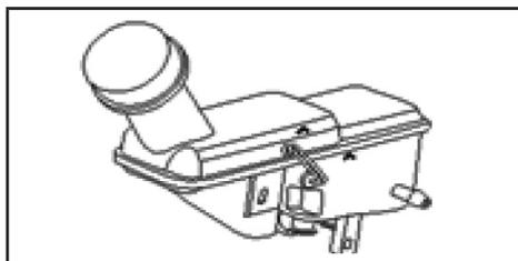
این سطح همواره باید بین دو علامت MIN (حداقل) و MAX (حداکثر) قرار گیرد. در صورت روشن شدن چراغ هشدار سطح روغن ترمز در صفحه کیلومتر، یعنی سطح روغن ترمز کاهش یافته است، توصیه می‌شود در اسرع وقت روغن ترمز اضافه نمایید. سطح روغن ترمز نباید پایین‌تر از علامت MIN قرار گیرد. چنانچه پس از اضافه نمودن روغن ترمز، این چراغ هشدار خاموش نگردد، لطفاً جهت بررسی و تعمیر با نمایندگی مجاز خدمات پس از فروش بهمن تماس بگیرید.
