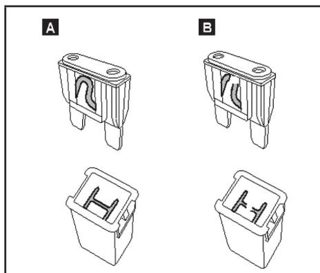
اگر تجهیزات برقی خودرو عملکرد ندارد، لطفاً فیوز مربوطه را بررسی کنید، چنانچه فیوز سوخته باشد لازم است فیوز را تعویض نمود.
