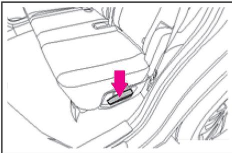
دستگیره تنظیم را بکشید و پشتی صندلی را با تغییر زاویه خم شدن بدن در موقعیت مناسب تنظیم نمایید. میزان حرکت صندلی در جهت افقی حدود  $2 \text{ mm} \pm$  است، که با توجه به موقعیت طراحی شده، صندلی را می‌توانید  $160 \text{ mm}$  به سمت جلو حرکت دهید. زاویه
