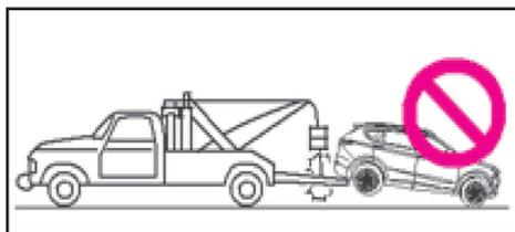
۲. یدک‌کشی با استفاده از کامیون جرثقیلی از عقب خودرو در حالی که چرخ‌های جلو روی زمین قرار داشته باشند.
