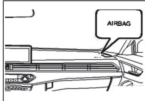
کیسه هوای سرنشین جلو در داشبورد قرار دارد که با علامت "SRS AIRBAG" مشخص شده است.
