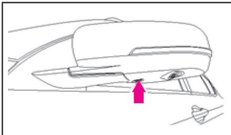
هنگام باز کردن درب‌ها این چراغ روشن می‌شود. چنانچه درب‌های خودرو یا درب پشتی باز شوند (دکمه خاموش و روشن خودرو در هر موقعیتی قرار داشته باشد) این چراغ روشن شده و در حدود ۳ دقیقه روشن می‌ماند (به تدریج روشن و بعد محو می‌شود).
