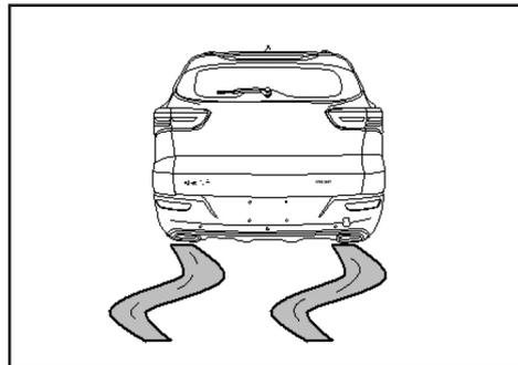
شتاب‌گیری سریع در جاده‌های لغزنده مانند جاده‌های پوشیده از برف و یخ ممکن است باعث لیز خوردن چرخ‌های عقب و انحراف خودرو شود. بنابراین با سرعت پایین و با احتیاط رانندگی نمایید.
