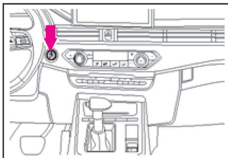
دکمه خاموش و روشن خودرو در سمت چپ پند کلیدهای کنترل سیستم تهویه مطبوع قرار دارد.
