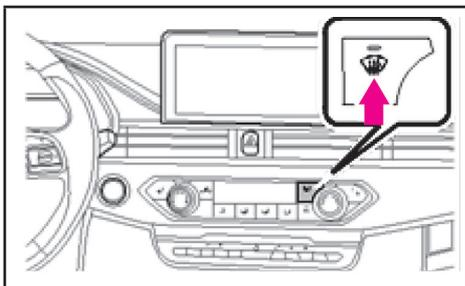
بیشتر جریان هوا به سمت شیشه جلو هدایت می‌شود. برای جلوگیری از بخار گرفتن شیشه جلو، زمانی که کلید مدور تنظیم جریان هوا در موقعیت OFF قرار ندارد، چنانچه حالت گرمکن شیشه جلو فعال شود، حالت ورود هوای بیرون و کمپرسور کولر فعال شود و عملکرد سرمایشی سیستم تهویه مطبوع راه‌اندازی می‌شود.
