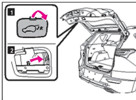
۱. کلید باز کردن اضطراری درب پشتی در روکش داخلی درب پشتی قرار دارد.
