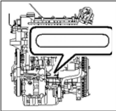
شماره موتور مطابق تصویر روی بلوک موتور حک شده است.
