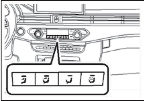
با استفاده از این دکمه‌ها، حالت دریچه خروج هوا تنظیم می‌شود. با فشار دادن این دکمه، حالت دریچه خروج هوای مربوطه در صفحه نمایشگر مالتی مدیا نمایش داده می‌شود، هر بار که این دکمه را فشار می‌دهید، حالت دریچه خروج هوا به ترتیب روشن یا خاموش می‌شود.
