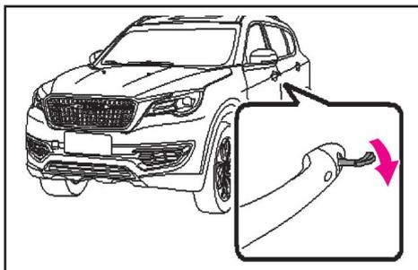
جهت باز کردن قفل خودرو با استفاده از کلید مکانیکی، ابتدا کلید مکانیکی را از کلید هوشمند خارج نمایید (دکمه کوچکی در پشت کلید هوشمند وجود دارد) کلید مکانیکی را وارد مغزی قفل درب کرده و برای باز کردن قفل خودرو، کلید را به سمت راست بچرخانید.
