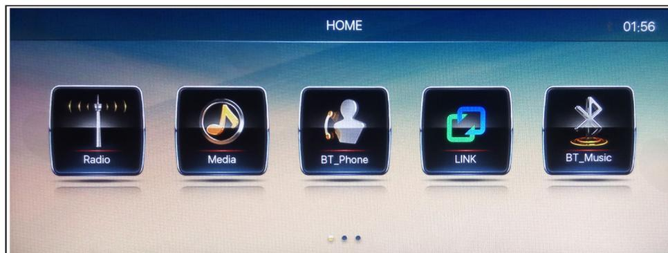
سیستم مالتی مدیای این خودرو مجهز به امکاناتی نظیر پخش رادیو در باند AM و FM، پخش فایل های صوتی ، تصویری و ویدیویی از طریق درگاه USB، اتصال بلوتوث، اتصال گوشی هوشمند، اتصال IPOD، پخش تصاویر DVR، نمایش دوربین پیرامون خودرو و منوی تنظیمات خودرو می باشد. لطفاً جهت کسب اطلاعات بیشتر در خصوص عملکرد سیستم مالتی مدیا به بروشور راهنمای مربوطه و یا صفحه راهنمای داخل سیستم مالتی مدیا مراجعه نمایید.
