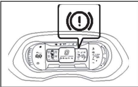
زمانی که دکمه خاموش و روشن خودرو در موقعیت ON (روشن) قرار دارد این چراغ عمل می‌کند. در صورت کاهش سطح روغن ترمز، این چراغ هشدار روشن خواهد شد. در صورت وجود ایراد، هرگز به رانندگی با خودرو ادامه ندهید. اگر ایرادی وجود ندارد، سطح روغن ترمز را از نظر کاهش سطح روغن بررسی نمایید. چنانچه سطح روغن ترمز کاهش یافته است، بلافاصله روغن ترمز اضافه نمایید تا سطح روغن بین دو علامت MIN (حداقل) و MAX (حداکثر) قرار گرفته و پس از آن برای بررسی سیستم ترمز به نمایندگی مجاز خدمات پس از فروش بهمن مراجعه نمایید.
