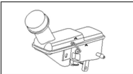
۱. سطح روغن ترمز باید بین علامت "MIN" (حداقل) و "MAX" (حداکثر) قرار داشته باشد. در صورت کاهش سطح روغن تا علامت "MIN" یا پایین تر از آن، بایستی روغن ترمز اضافه شود. برای دانستن علت کاهش روغن ترمز لطفاً به نمایندگی مجاز خدمات پس از فروش بهمن مراجعه کنید.
