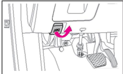
۱. برای باز کردن قفل درب موتور، اهرم باز شدن درب موتور را بکشید.
