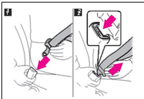
هنگام بستن کمربند ایمنی، آن را به آرامی بیرون بکشید. زمانی که خودرو روی سطح شیب‌دار قرار دارد و کمربند ایمنی را با سرعت بیرون بکشید، ممکن است کمربند ایمنی قفل شود. کمربند روی شانه را حتماً از وسط شانه عبور دهید. کمربند روی پاها را باید تا جایی که ممکن است از نزدیک لگن عبور دهید، کمربند ایمنی روی پاها نباید از روی شکم عبور داده شود.
