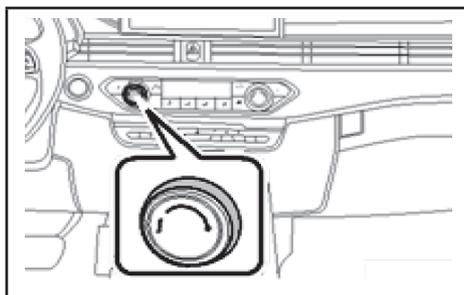
کلید مدور تنظیم جریان هوا دارای ۸ سطح (۰-۷) است. زمانی که کلید مدور کاملاً در سمت راست قرار می‌گیرد سطح ۷ و زمانی که کاملاً در سمت چپ قرار می‌گیرد سطح ۰ خواهد بود. برای خاموش کردن فن، کلید مدور را در سطح ۰ قرار دهید. در زمان کار با پنل کنترل سیستم تهویه مطبوع، میزان جریان هوا، حالت و تنظیمات سیستم گرمایشی/سرمایشی در صفحه نمایشگر مالتی مدیا نشان داده می‌شود.
