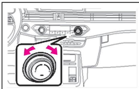
دمای هوای خروجی از دریچه‌های خروج هوا با کلید تنظیم دما قابل تنظیم می‌باشد که با چرخش کلید به
