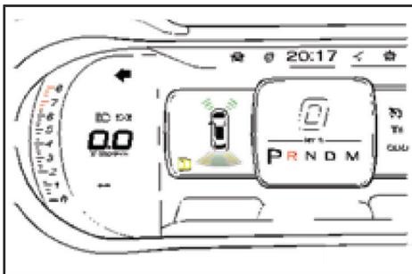
سیستم نظارت بر نقاط کور خودرو یک سیستم کمکی در رانندگی است که بر اساس فناوری رادار کار می‌کند و شامل عملکردهای تشخیص نقطه کور، هشدار عبور و مرور در امتداد عقب خودرو و هشدار باز ماندن درب خودرو است
