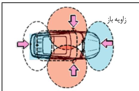
سیستم کمکی پانورامیک پارک دارای چهار دوربین پیشرفته مدار بسته است که در جلو، عقب، سمت راست و چپ خودرو قرار دارند. همزمان با جمع‌آوری تصاویر اطراف خودرو، تصاویر به واحد پردازش تصاویر انتقال می‌یابد و در آخر تصویر پانورامیک ۳۶۰° از بالای خودرو و به صورت کامل نشان داده می‌شود. در حالی که سیستم تصویر گسترده را نشان می‌دهد، قادر است تصویری تک از یک سمت خودرو و موقعیت صحیح قرارگیری و فاصله تا مانع پشت سر را با استفاده از یک خط راهنما نشان دهد.
