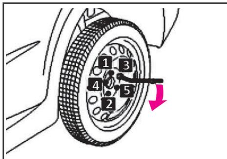
با استفاده از آچار چرخ، پیچ‌های چرخ را به ترتیب نشان داده شده در تصویر سفت نمایید. برای اطمینان از محکم شدن پیچ‌های چرخ، سفت کردن پیچ‌ها را ۲ تا ۳ بار
