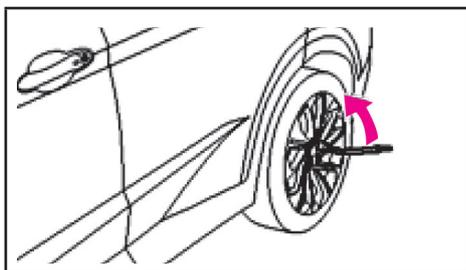
قبل از جک‌زدن خودرو، پیچ‌های چرخ‌ها را باید تعویض شود را با استفاده از آچار چرخ و چرخاندن آن در خلاف جهت حرکت عقربه‌های ساعت شل نمایید. از حداکثر گشتاور برای شل کردن پیچ‌های چرخ استفاده کنید، آچار چرخ را روی پیچ قرار داده و دسته جک را در سمت چپ آچار چرخ قرار دهید، سپس انتهای دسته جک را گرفته و به سمت پایین فشار دهید.
