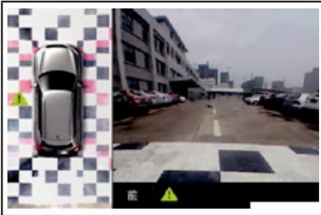
اگر در یکی از دوربین‌ها قطع مدار یا اتصال کوتاه تشخیص داده شود، تصویر به صورت سیاه نمایش داده شده و تصویر هشدار زرد رنگی در محدوده مربوطه دارای ایراد، نشان داده می‌شود.
