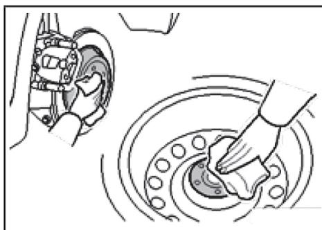
قبل از نصب چرخ زاپاس، با استفاده از پارچه‌ای تمیز، آلودگی روی سطح چرخ زاپاس ر ۱۳ تمیز کنید. مطمئن شوید که توپی چرخ به طور مناسب با سطح چرخ تماس داشته باشد. در غیر این صورت پیچ‌های چرخ شل شده و
