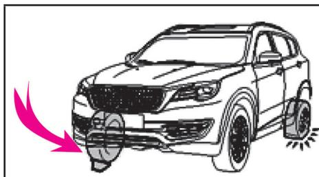
در صورت جک‌زدن خودرو، بلوک مانع را در چرخ مورب با چرخ پنچر شده (مطابق تصویر) قرار دهید تا از حرکت چرخ‌ها جلوگیری شود.
