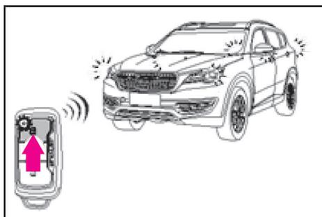
زمانی که دکمه خاموش و روشن خودرو در موقعیت OFF (خاموش) قرار دارد و چهار درب خودرو و درب پشتی بسته می‌باشند، دکمه قفل روی کلید را فشار دهید تا خودرو قفل شود (چهار درب خودرو قفل شده، چراغ‌های راهنما یکبار چشمک‌زده و آژیر هشدار سیستم ضد سرقت (دزدگیر) یکبار شنیده می‌شود).
