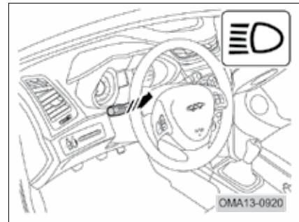
کلید تنظیم ارتفاع نور پایین چراغ جلو در پایین صفحه کیلومترشمار و در سمت چپ آن واقع شده است. برای تنظیم ارتفاع نور پایین می‌توانید این کلید را بچرخانید. این کلید دارای ۴ سطح تنظیم «۰۰»، «۱۱»، «۲۲» و «۳۳» می‌باشد. برای انتخاب زاویه مورد نظر برای نور پایین چراغ جلو، کلید را در یکی از موقعیت‌های چهارگانه بگذارید.
