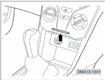
جا کارتی در بالای محفظه‌ی جلوی دسته دنده قرار گرفته و مناسب برای نگهداری انواع کارت می‌باشد.
