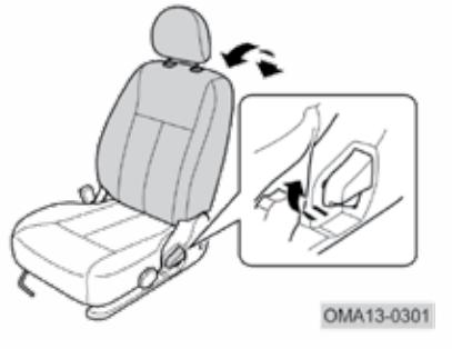
برای تنظیم زاویه پشتی صندلی جلو، اهرم کناری صندلی را بکشید و هم‌زمان پشتی را تا رسیدن به موقعیت دلخواه حرکت دهید و سپس اهرم را رها کنید. از ثابت شدن پشتی صندلی پس از تنظیم شدن آن، اطمینان یابید.
