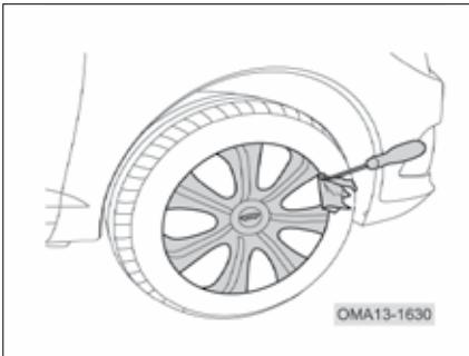
۵ برای خودرویی که دارای قالپاق می‌باشد، ابتدا با پیچ‌گوشی سرتخت که سر آن پارچه پیچیده شده است، قالپاق را از رینگ چرخ جدا کنید (مطابق شکل).
