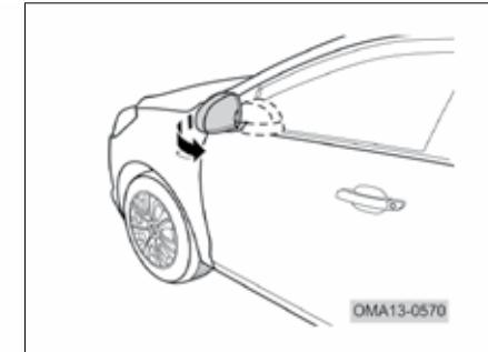
هنگام پارک کردن و یا عبور از محل‌های باریک و در صورت نیاز می‌توانید آینه‌ها را با دست به سمت داخل جمع کنید. برای برگرداندن آن به حالت اول، آن را به سمت بیرون فشار دهید.
