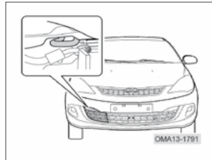
با استفاده از پیچ گوشتی تخت، شبکه زیرین سپر را باز کنید تا سیم بکسل به راحتی در بکسل بند بسته شود.
