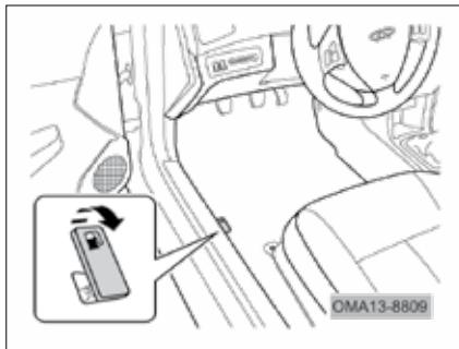
۱. اهرم آزادکننده درب باتری که در سمت چپ صندلی راننده قرار دارد را بکشید تا درب باتری باز شود.
