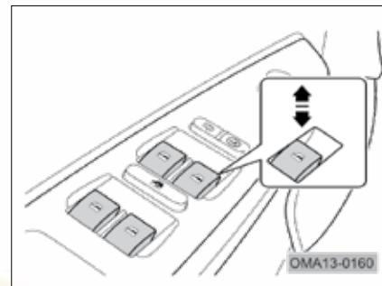
کلید اصلی شیشه بالابرها بر روی درب راننده تعییه شده است. برای باز کردن هر کدام از شیشه‌ها، کلید مربوط به همان شیشه را فشار داده و نگه دارید. زمانی که شیشه به موقعیت
