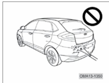
هنگام کارواش و شستن خودرو، برای تمیز کردن سنسورها از پارچه نرم استفاده کنید و برای شستن گل و لای و یخ از روی سنسورها از آب با فشار کم استفاده کنید. از شستن سنسورها با آب پر فشار و به طور مستقیم جدا خودداری کنید. زیرا با این عمل سنسورها تحت فشار قرار گرفته و آسیب خواهند دید.
