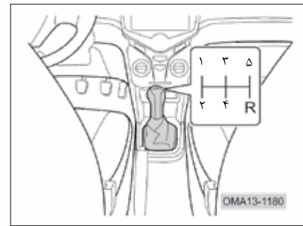
این خودرو به گیربکس دستی و معمولی مجهز می باشد. قبل از تعویض دنده، ابتدا پدال کلاچ را تا انتهای فشار دهید و پس از تعویض شدن دنده به آرامی پدال کلاچ را رها کنید. در غیر این صورت در کلاچ لغزش ایجاد می شود و منجر به ساییدگی کلاچ خواهد شد.
