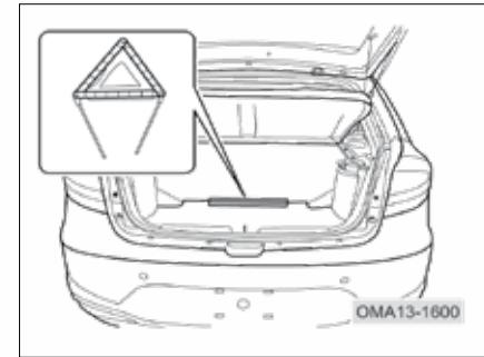
برای اعلام هشدار، در صندوق عقب این خودرو یک مثلث خطر تعییه شده است. جهت استفاده، کاور صندوق را بلند کنید و مثلث خطر را از جعبه مخصوص آن خارج کنید و به شکل مثلث تنظیم نمایید. اگر خودرو تصادف کرده باشد یا این که قادر به حرکت نمی‌باشد، جهت هشدار دادن و اعلام خطر به سایر رانندگان از مثلث خطر استفاده کنید.
