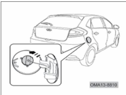
۲. در پوش لوله باتری را در خلاف جهت حرکت عقربه‌های ساعت بچرخانید تا باز شود، سپس اقدام به پر کردن باتری و سوخت‌گیری نمایید.
