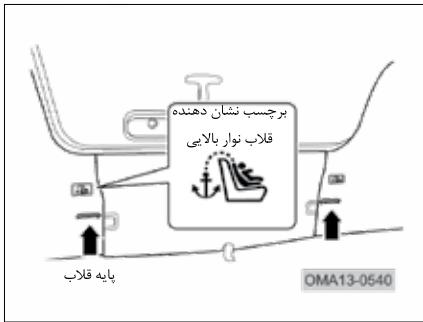
برای وصل کردن نوار نگهدارنده بالایی، دو عدد زبانه در صندوق عقب و پشت صندلی عقب نصب کنید.
