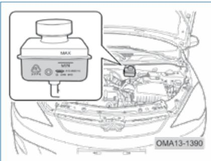
مخزن روغن ترمز در سمت عقب و چپ موتور قرار گرفته است. سطح روغن ترمز نیز باید بین دو شاخص "MAX" و "MIN" مخزن باشد. سطح روغن ترمز را مرتبا چک کنید. اگر سطح روغن ترمز از شاخص "MIN" کمتر باشد، چراغ هشدار پنل صفحه کیلومتر روشن خواهد شد، در این حالت خودرو را در یک نقطه امن پارک کنید و فورا با یکی از نمایندگی های مجاز تماس بگیرید تا عیب را برطرف کنند.
