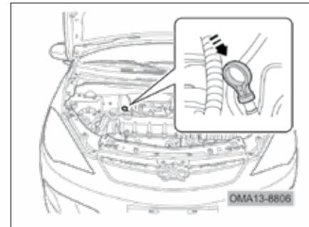
۴. سپس گیج را دوباره بیرون بکشید و سطح روغن را بررسی کنید. سطح روغن استاندارد باید بین دو علامت "MAX" (بیشترین) و "MIN" (کمترین) باشد. برای سرریز کردن و اضافه کردن روغن، لطفاً به فصل ۶ «روغن موتور» مراجعه کنید.
