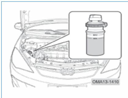
وقتی که موتور سرد می‌باشد، سطح روغن هیدرولیک داخل مخزن باید بین دو شاخص "MIN" و "MAX" باشد. در صورتی که روغن کمتر از "MIN" می‌باشد به آن اضافه کنید. روغن هیدرولیک مورد استفاده باید مطابق با استانداردهای شرکت مدیران خودرو باشد.
