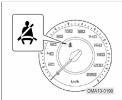
با باز شدن سویچ، چراغ کمربند راننده به طور متواتی چشمک خواهد زد و تا زمانی که کمربند راننده به درستی بسته نشود، خاموش نخواهد شد. همچنین اگر کمربند بسته نشود، در سرعت‌های ۲۵km/h یا بالاتر، بوق اخطاری جهت یادآوری به صدا در خواهد آمد.
