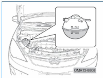
سطح مایع خنک کاری در مخزن انبساط باید بین دو شاخص "MAX" (بیشترین) و "MIN" (کمترین) مطابق شکل باشد. در صورتی که سطح مایع کمتر از "MIN" است، هر چه سریع تر نسبت به اضافه کردن آب به مخزن اقدام نمایید. برای نحوه اضافه کردن آب به مخزن، لطفاً به فصل ۶ «مایع خنک کننده» مراجعه نمایید.
