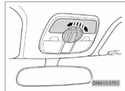
کلید چراغ سقف دارای سه حالت می‌باشد. وقتی که در موقعیت "ON" باشد، چراغ سقف همیشه روشن می‌ماند. اگر در موقعیت "OFF" قرار گیرد، چراغ سقف خاموش خواهد شد. اگر در موقعیت "DOOR" قرار داشته باشد، هر زمان که یکی از درب‌ها باز شود، چراغ سقف نیز روشن خواهد شد. پس از بسته شدن درب، چراغ سقف در مدت ۱۵ ثانیه به تدریج کم نور شده و سپس خاموش خواهد شد.
