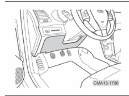
جعبه فیوز و رله داخل اتاق در سمت چپ و زیر تلسکوپی فرمان قرار دارد و جعبه فیوز اصلی خودرو محسوب می‌شود. برای رویت این جعبه فیوز، کاور زیر تلسکوپی را باز کنید.
