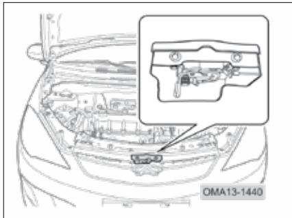
قفل درب موتور موجب می‌شود که درب موتور به درستی و به طور محکم بسته بماند و از باز شدن آن هنگام رانندگی جلوگیری می‌شود.
