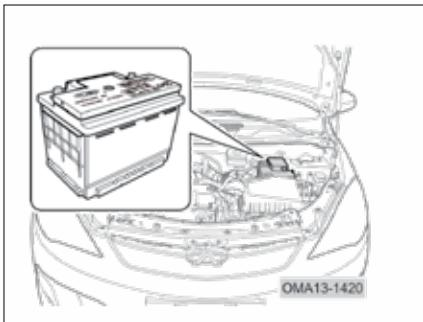
باتری استفاده شده در این خودرو نیازی به نگهداری و اضافه کردن آب مقطر ندارد. توصیه می‌شود که هنگام تعویض باتری و استفاده از نوع جدید، مشخصات باتری نو از قبیل ولتاژ، جریان و ... باید منطبق با باتری قدیمی و مشخصاتی که توسط شرکت مدیران خودرو توصیه می‌شود، باشد.
