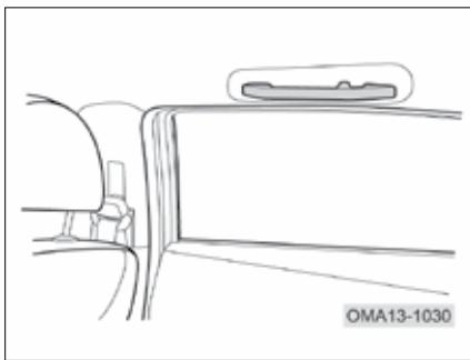
در بالای سرنشیانان جلو و عقب خودرو یک عدد دستگیره نصب شده است. هنگام عبور خودرو از مناطق ناهموار، سرنشیانان می‌توانند برای حفظ اینمی این دستگیره‌ها را بگیرند. روی دستگیره‌های سقف چند عدد قلاب نیز جهت آویزان کردن لباس قرار داده شده است. اجسام سخت و نوکتیز را از این قلاب‌ها آویزان نکنید، در غیر این صورت در زمان تصادفات ممکن است باعث ایجاد جراحت شوند.
