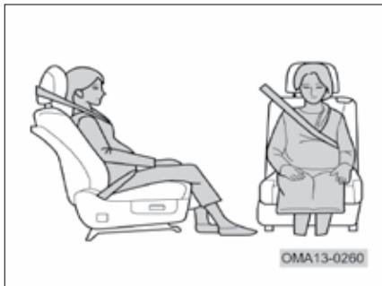
ضمن کسب اطلاعات و توصیه‌های پزشکی کافی، کمربند ایمنی را به طور صحیح مورد استفاده قرار دهید. بانوان باردار می‌بایست تسمه پایینی کمربند را تا جایی که امکان دارد پایین برده و در بالای لگن قرار دهند. تسمه بالای را از بالای شانه کشیده و از قفسه سینه عبور دهنده و اجازه ندهنده که کمربند با ناحیه شکم‌شان برخوردی داشته باشند.
