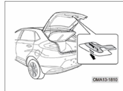
برای خروج اضطراری از خودرو، دستگیره خروج در صندوق عقب تعییه شده است. در صورت وقوع تصادف و قفل شدن هر چهار درب، صندلی‌های عقب را تا کنید و دستگیره خروج اضطراری در روی درب صندوق عقب را مholm به سمت داخل بکشید تا درب صندوق باز شود تا امکان خروج مهیا شود.
