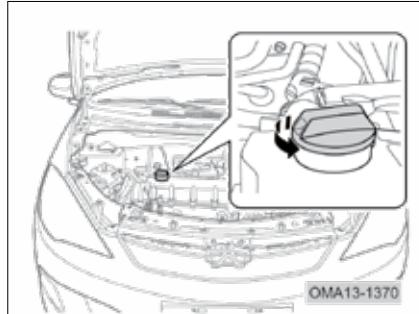
برای ریختن روغن داخل موتور، ابتدا درب روغن را در خلاف جهت حرکت عقربه‌های ساعت بچرخانید تا باز شود و پس از ریختن روغن، آن را در جهت حرکت عقربه‌های ساعت بچرخانید تا به خوبی سفت شود.
