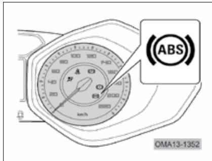
پس از باز کردن سویچ و قرار دادن آن در موقعیت "ON" چراغ چک ABS روشن می شود و بلافاصله خاموش می شود تا صحت عملکرد سیستم به طور اتوماتیک چک شود.
