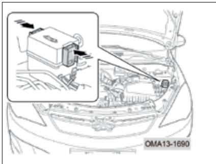
جعبه رله در سمت چپ محفظه موتور قرار گرفته است. برای باز کردن در پوش جعبه رله، خارهای دو طرف آن را به سمت داخل فشار دهید.
