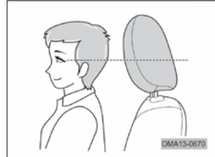
پشتسری باید به گونه‌ای تنظیم شود که خط مرکزی آن از نزدیکی‌های بالای گوش رد شود و سر شما در مرکز پشتسری قرار گیرد.
