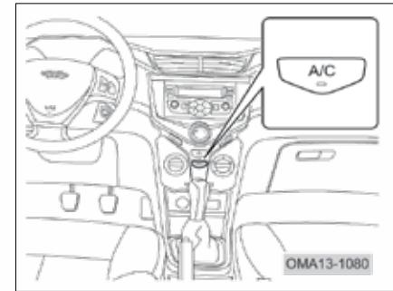
زمانی که موتور روشن است، فن تهویه مطبوع را روشن کرده و کلید A/C را فشار دهید. چراغ روی کلید روشن شده و کمپرسور کولر جهت تولید هوای سرد شروع به کار خواهد کرد. برای خاموش کردن کولر، کلید A/C را مجدداً فشار دهید.
