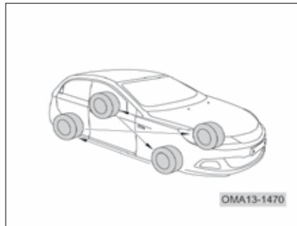
پس از پیمایش و کارکرد کیلومتر به مقدار مشخص، جابه‌جایی تایرها باعث می‌شود که سایش تایرها یکنواخت شود و عمر آن‌ها افزایش یابد.
