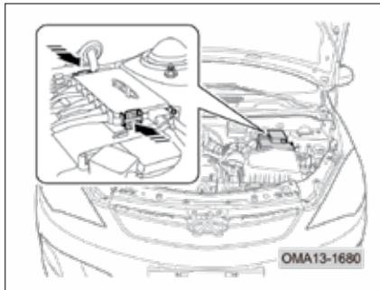
جعبه فیوز قدرت در داخل محفظه موتور و روی باتری قرار گرفته است. برای باز کردن در پوش آن، خارهای دو طرف را به سمت داخل فشار دهید.
