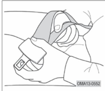
برای افزایش طول کمربند، آن را به صورت زاویه‌دار در دست گرفته و نوار پایینی آن را بشکید تا به اندازه مورد نظر برسید. برای باز کردن کمربند، دکمه قرمز رنگ "PRESS" بر روی قفل کمربند را فشار دهید.
