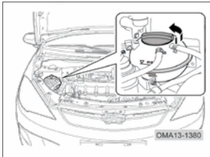
برای اضافه کردن مایع خنک کننده، ابتدا درب مخزن انبساط را نیم دور در خلاف جهت حرکت عقربه‌های ساعت بچرخانید تا فشار درون آن تخلیه شود. سپس آن را به طور کامل باز کنید و به مخزن، مایع خنک کننده به اندازه توصیه شده (بین دو علامت "MIN" و "MAX") اضافه کنید. پس از قطعات سیستم خنک کننده از جنس آلومینیوم می‌باشد. در صورت عدم استفاده از ضدیخ یا استفاده از مایع نامناسب باعث می‌شود که قطعات فوق دچار خوردگی شوند. هر چند ممکن است روی برخی از محلول‌های ضدیخ
