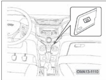
برای از بین بردن رطوبت، برف و یا بخهای روی شیشه عقب، از گرم کن شیشه عقب استفاده می‌شود. برای روشن و خاموش کردن گرم کن، از دکمه مربوطه بر روی داشبورد استفاده کنید. گرم کن شیشه عقب، ۱۵ دقیقه پس از روشن شدن، به طور خودکار خاموش خواهد شد. برای روشن کردن مجدداً دکمه را فشار دهید.
