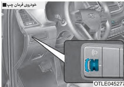
نوع دستی برای تنظیم زاویه چراغ های جلو با توجه به تعداد سرنشینان و وزن بار در قسمت بار، سوئیچ تنظیم زاویه چراغ را بچرخانید.
