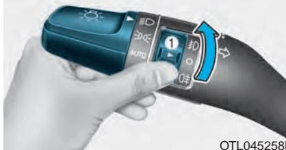
چراغ مه شکن جهت بهبود دید، هنگامی که دید در مه، باران یا برف محدود می شود تعیینه گردیده است. از کلید کنار کلید چراغ جلو جهت روشن و خاموش کردن چراغ مه شکن استفاده نمایید.
