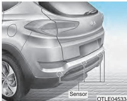
سیستم کمک پارک دنده عقب به راننده در زمان حرکت به عقب با اعلام هشدار صوتی هنگام نزدیک شدن تا فاصله ۱۲۰ سانتیمتری (۵۰ اینچی) اجسام پشت خودرو، کمک می نماید.
