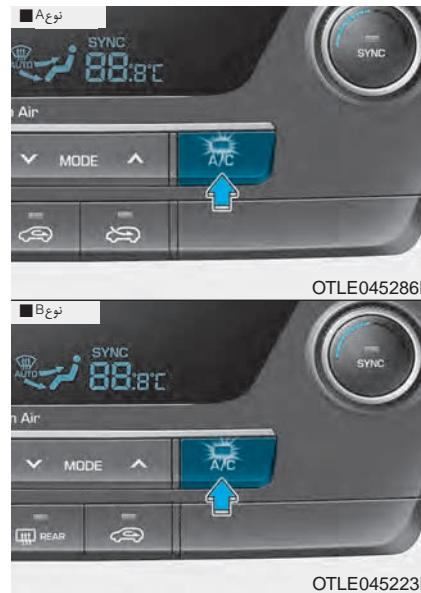
دکمه A/C را جهت روشن شدن سیستم تهویه هوافشار دهید (چراغ نشانگر روشن می شود). دکمه را مجدداً جهت خاموش کردن سیستم تهویه هوافشار دهید.
