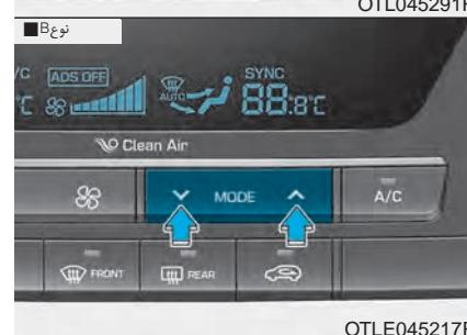
ذکمه انتخاب حالت، مسیر (جهت) گردش هوا از طریق سیستم تهویه هوا را کنترل می نماید.
