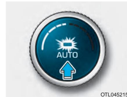
حالات، دور فن، ورودی هوا و تهویه ها به صورت اتوماتیک با توجه به تنظیمات دما کنترل می شوند.
