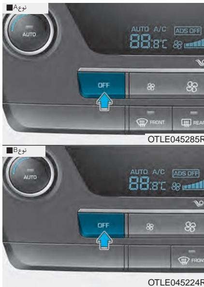
دکمه OFF جلو را جهت خاموش کردن سیستم کنترل دما فشار دهید. با این وجود می توانید کماکان از دکمه های حالت و ورودی هواتا زمانی که سوئیچ در وضعیت ON قرار دارد، استفاده نمایید.
