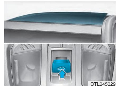
اگر اهرم کنترل سانروف را به جلو فشار دهید، سایه بان به صورت کامل باز شده و شیشه سانروف متمایل می شود.
