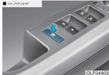
راننده قادر است با فشردن کلید قفل شیشه برقی بر روی درب راننده و تغییر آن به وضعیت LOCK (با فشردن آن قفل می‌شود)، شیشه‌های برقی عقب را فعال کند. هنگامی که کلید قفل شیشه برقی فشرده شود:
