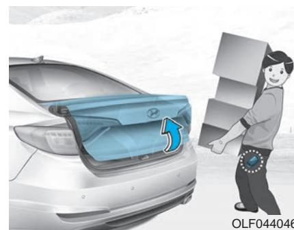
در خودروی مجهز به کلید هوشمند، درب صندوق عقب می‌تواند با استفاده از سیستم درب صندوق عقب هوشمند باز شود.
