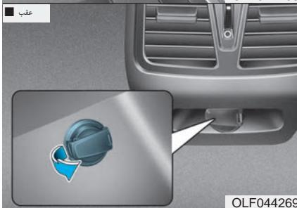
پریز برق به منظور تهیه برق برای تلفن های همراه یا دیگر وسایل برای کار با سیستم برقی خودرو طراحی شده است. دستگاهها بایستی کمتر از ۱۸۰ وات را در حین کارکردن موتور مصرف کنند.
