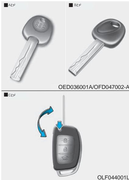
درصورتی که ریموت به درستی عمل نمی‌کند، می‌توانید قفل درب‌ها را با استفاده از کلید مکانیکی باز و بسته نمایید.
