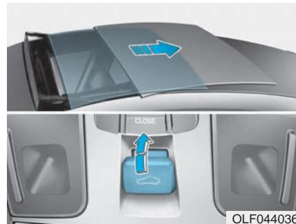
با کشیدن اهرم کنترل سانروف به سمت عقب، سایبان به طور کامل به صورت کشویی باز شده و پس از آن سانروف به طور کامل باز خواهد شد. برای متوقف کردن سانروف در هر نقطه دلخواه، اهرم کنترل سانروف را در آن لحظه بکشید یا فشار دهید.
