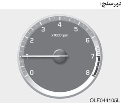
دورسنج سرعت تقریبی چرخش موتور را به صورت دقیقه (rpm) نشان می دهد. از دورسنج برای انتخاب صحیح نقطه تعویض دند و جلوگیری از پس زدن موتور یا جلوگیری از دورگرفتن بیش از حد موتور استفاده کنید.
