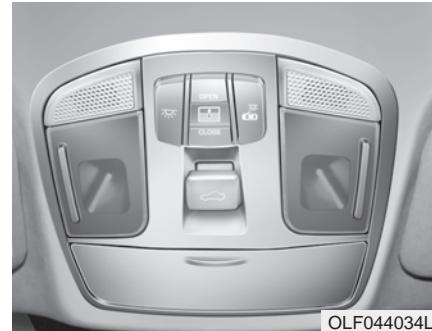
در صورت مجهز بودن خودروی شما به سانروف، با استفاده از اهرم کنترل سانروف قادر به ژاویه دادن و یا کنار زدن آن خواهد بود. پیش از آن که بتوانید سانروف را باز کرده یا ببندید، می بایست سوئیچ در وضعیت ON قرار گرفته باشد.
