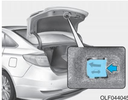
خودرو شما مجهز به اهرم بازنگنده این من درب صندوق عقب به صورت اضطراری در داخل صندوق عقب می باشد. هنگامی که کسی به طور اتفاقی در صندوق عقب گیرافتاده باشد، می توان با حرکت دادن اهرم در جهت فلش و فشار درب صندوق عقب آن را باز کرد.
