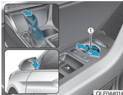
با بردن دنده به وضعیت R (عقب) آینه های بغل به منظور کمک به رانندگی به سمت عقب، به سمت پایین خواهند چرخید.
