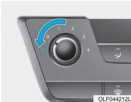
برای کار با فن، می بایست سوئیچ خودرو در وضعیت ON باشد.
