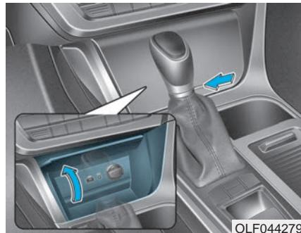
برای باز کردن درپوش درپوش را فشار داده تا به آرامی باز شود. برای بستن درپوش، آن را فشار دهید تا بسته شود.
