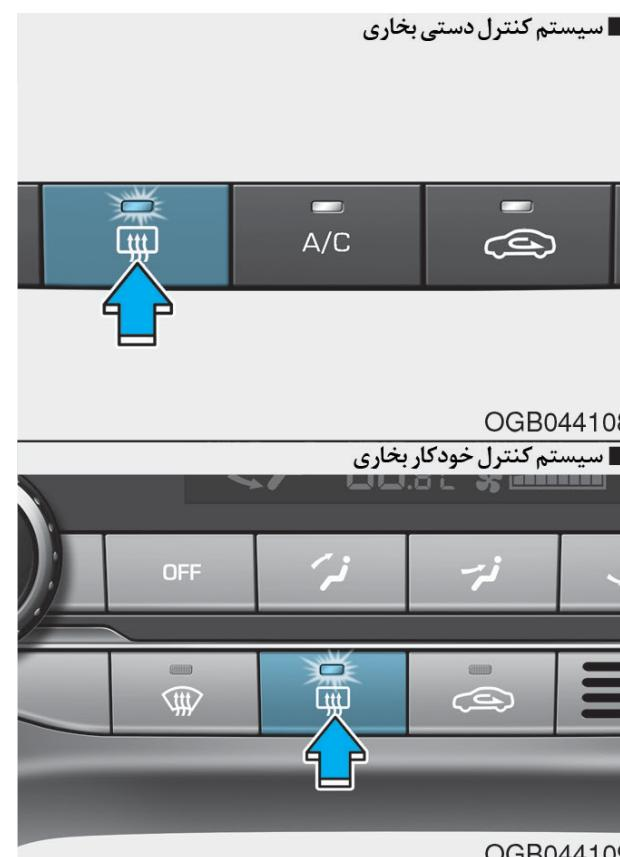
این بخاری شیشه را گرم می‌کند تا یخ زدگی، بخار و لایه نازک یخ روی قسمت داخلی و بیرونی شیشه عقب در موقع کار کردن موتور، تمیز شود.
