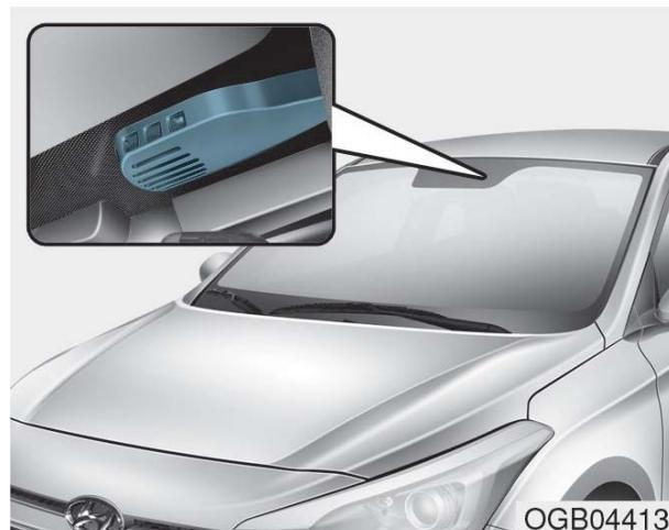
بخار زدایی خودکار سبب کاهش احتمال بخار گرفتگی سطح داخلی شیشه می‌شود زیرا به صورت خودکار رطوبت داخلی شیشه را تشخیص می‌دهد. سیستم بخار زدایی خودکار وقتی فعال می‌شود که بخاری یا کولر روشن باشد.
