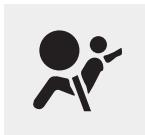
بعد از این که سوئیچ را در حالت روشن قرار می‌دهید چراغ اخطار کیسه هوا SRS در جلو داشبورد به مدت ۶ ثانیه روشن خواهد شد که بعد از آن این چراغ باید خاموش شود.
