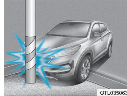
کیسه های هوا ممکن است در صورت برخورد خودرو با اجسامی مانند میله ها یا درختان که محل برخورد به صورت متمرکز بوده و نیروی برخورد توسط ساختار خودرو جذب می گردد، باز نشود.
