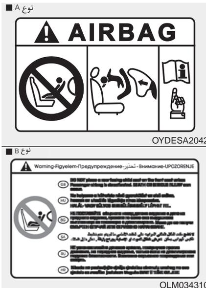
هیچوقت سیستم صندلی کودک را در صندلی سرنشین جلو نصب نکنید. باز شدن کیسه هوا می تواند با شدت به کودک یا سیستم صندلی ضربه وارد کرده و
