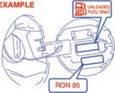
اگر خودروی شما دارای یک محدود کننده در لوله باک بنزین نبوده و برقسپ " فقط بنزین بدون سرب " بر روی درب باک نصب نشده باشد، در آنصورت شما می توانید از هر دو نوع بنزین سرب دار یا بدون سرب با عدد اکتان ۹۱ یا بالاتر استفاده نمایید.
