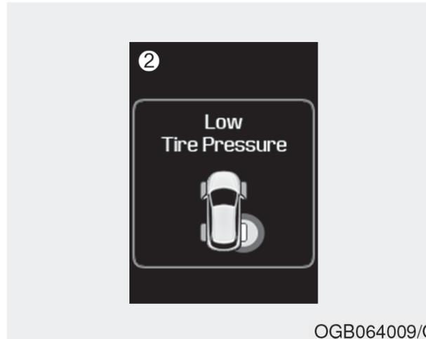
همیشه چراغ ایراد TPMS را بعد از تعویض یک یا چند لاستیک یا چرخ در خودرو چک کنید تا اطمینان پیدا کنید که لاستیک‌های تعویض شده و یا جایگزین به‌گونه‌ای هستند که اجازه می‌دهند تا TPMS مجدداً عمل کند.
