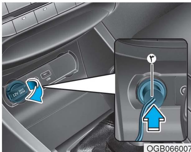
۷. در وضعیتی که کلید روشن / خاموش خودرو در وضعیت روشن است و یا سوئیچ باز است، کمپرسور را روشن و اجازه دهید تا ۵ تا ۷ دقیقه کار کند تا درزگیر را تا فشار مناسب وارد کند. (به بخش چرخ و لاستیک خودرو در فصل ۸ مراجعه شود). فشار باد لاستیک بعد از پر کردن زیاد مهم نیست و بعداً چک و تنظیم می‌شود. مواظب باشید که لاستیک را زیاد باد نکنید و موقع باد کردن از لاستیک فاصله بگیرید.
