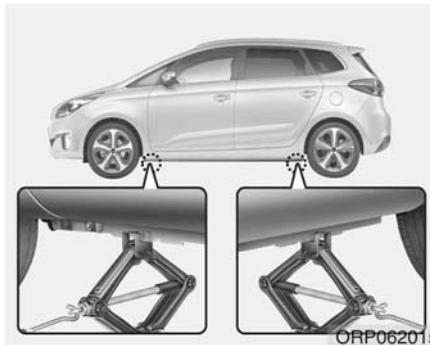
۷. جک را در نزدیک‌ترین موقعیت محل جک زدن نسبت به چرخ تعویضی جلو یا عقب قرار دهید. جک را در محل‌های جک زدن مشخص شده در زیر شاسی قرار دهید. محل‌های جک زدن صفحات فلزی دارای دو زائده و یک نقطه برآمده برای تطبیق با جک بوده که به شاسی جوش داده شده‌اند.
