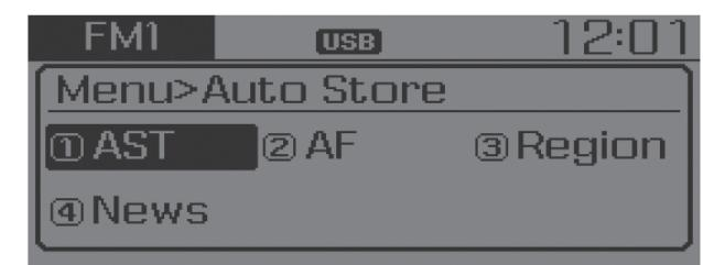
برای ذخیره فرکانس‌ها به ترتیب اولویت در کلیدهای AST (Auto Store) **1 ~ 6** انتخاب نمایید. اگر فرکانسی دریافت نشد، در آن صورت غالب فرکانس‌های جدید پخش می‌شوند.
