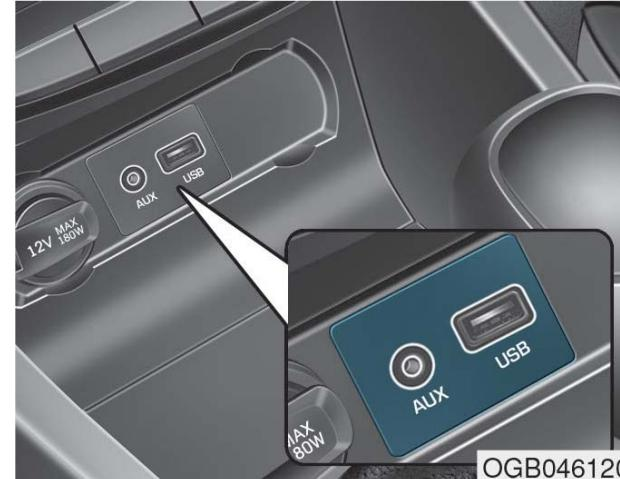
می‌توانید از پورت AUX برای اتصال وسایل صوتی و از پورت USB برای اتصال فلش مموری و نیز از پورت iPod® هم بدین منظور استفاده نمایید.
