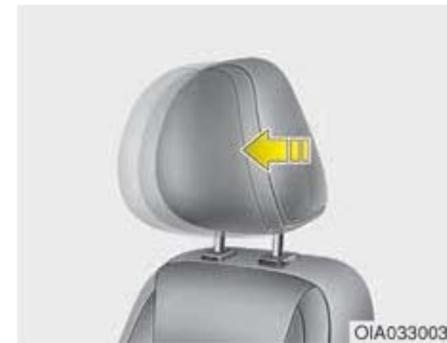
تنظیم گردنی (پشت سری) به جلو و عقب بخش گردنی (پشت سری) می‌تواند در سه وضعیت مختلف رو به جلو تنظیم شود و بدین منظور باید بخش گردنی (پشت سری) را تا دندانه مطلوب جلو کشید. برای تنظیم بخش گردنی (پشت سری) در دورترین موقعیت عقبی، آن را کاملاً به دورترین نقطه جلو بکشد و سپس آن را رها کنید.
