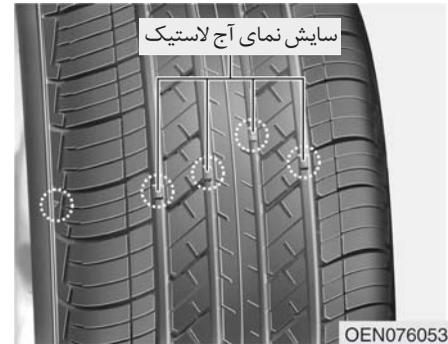
اگر لاستیک به طور یکنواخت سائیده شده باشد، سایش نمای آج لاستیک به صورت باند یک پارچه در عرض آج ظاهر می‌شود. این امر باقی ماندن کمتر از ۱/۴ میلیمتر از آج بر روی لاستیک را نشان می‌دهد. در صورت رخ دادن این وضعیت لاستیک را تعویض کنید. برای تعویض لاستیک تا زمان ظاهر شدن باند در عرض همه آج صبر نکنید.
