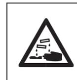
اگر آب باطری وارد چشم‌های شما شد، چشم خود را با آب تمیز برای مدت ۱۵ دقیقه بشویید و بلافاصله به پزشک مراجعه کنید. اگر آب باطری روی پوست شما ریخت، کاملاً سطح تماس را بشویید و اگر احساس درد یا سوزش می‌کنید، حتماً به پزشک مراجعه کنید.
