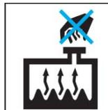
هرگز موقع کار کردن موتور و گرم بودن رادیاتور، درب آن را باز نکنید. در غیر این صورت بخار و مایع خنک کننده داغ با فشار خارج شده و می‌تواند به شما آسیب برساند.
