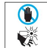
پروانه خودرو گاهی حتی در وضعیت خاموش بودن موتور هم کار می‌کند. بنابراین موقع روشن بودن نزدیک پره‌های پروانه احتیاط کنید تا به شما آسیب نرساند. با کاهش دمای مایع خنک کننده، موتور الکتریکی پروانه به صورت خودکار خاموش می‌شود و این شرایط عادی است.
