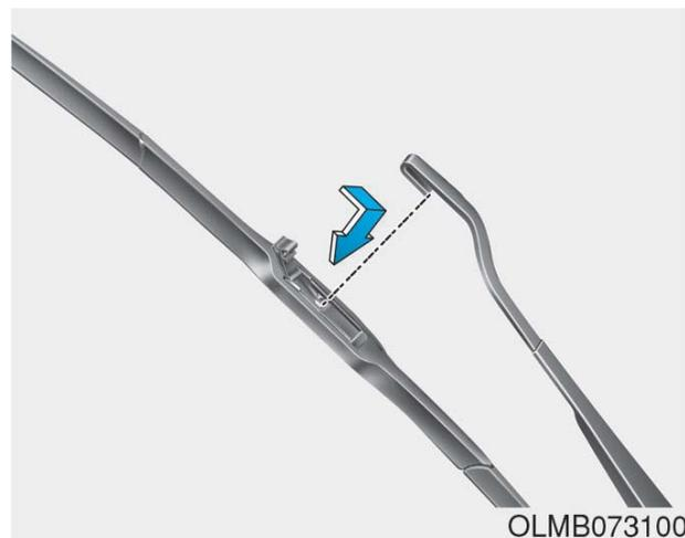
۳. برای بستن تیغه‌ها عکس روند باز کردن آن عمل کنید.
