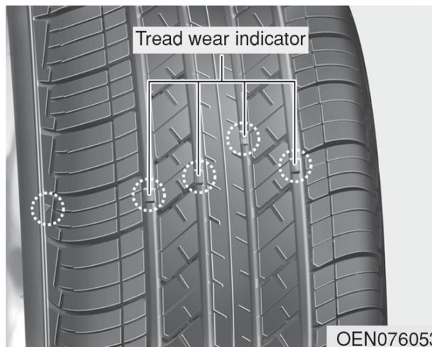
اگر لاستیک به صورت یکنواخت سائیده شده است، علامت سایش آج به صورت یک نوار توپر در داخل آج ظاهر می‌شود. این نوار نشان‌دهنده آن است که کمتر از ۱/۶ میلی‌متر آج باقی مانده است. در این وضعیت، لاستیک را باید عوض کنید. هرگز منتظر نشوید که این نوار در کل آج پیدا شود و سپس لاستیک را تعویض کنید.
