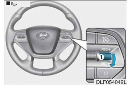
۳. اهرم (1) را به وضعیت (SET-) فشار داده و آن را آزاد کنید. چراغ نمایشگر SET بر روی صفحه نمایشگرها روشن می شود.
