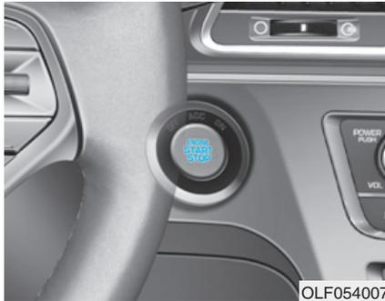
به محض باز شدن درب جلو، چراغ دکمه روشن / خاموش موتور روشن خواهد شد. این چراغ بلافاصله پس از تغییر موقعیت دکمه به حالت ON یا حدود ۳۰ ثانیه پس از بسته شدن درب خاموش خواهد شد.
