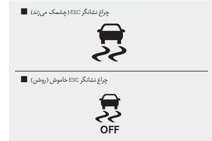
هنگامی که سوئیچ خودرو به وضعیت روشن ON چرخانده شود، چراغ نمایشگر روشن می‌شود سپس در صورت عادی بودن عملکرد سیستم خاموش ESC می‌شود.
