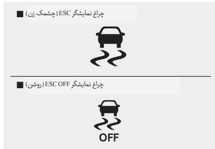
هنگامی که سوئیچ خودرو به موقعیت روشن ON چرخانده شود، چراغ نمایشگر روشن شده و در صورت عادی بودن عملکرد سیستم ESC، خاموش می‌شود.
