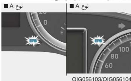
این چراغ هشدار در صورت تغییر دکمه روشن و خاموش کردن موتور به وضعیت ON روشن شده و در صورت عملکرد نرمال سیستم تقریباً پس از ۳ ثانیه خاموش خواهد شد.
