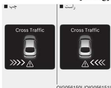
اگر خودرو توسط حسگر ها آشکار شود و مشخص گردد که در حال نزدیک شدن به خودرو شماست در آن صورت بوق هشدار به صدا در می آید و چراغ هشدار روی آینه بغل چشمک زده و پیغام روی نمایشگر LCD ظاهر می شود.
