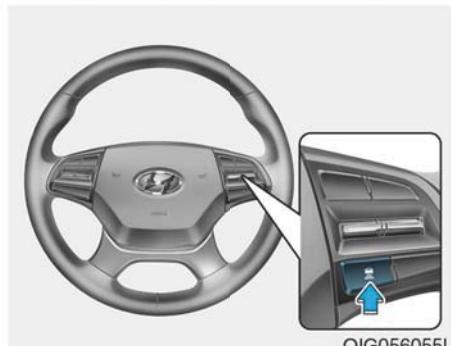
زمانی که سیستم کروز کنترل هوشمند فعال است، می‌توانید فاصله تا خودروی جلویی را تعیین و بدون نیاز به فشردن پدال گاز یا ترمز حفظ کنید. با هر بار فشردن دکمه فاصله تا خودرو جلویی بصورت زیر تغییر می‌یابد:
