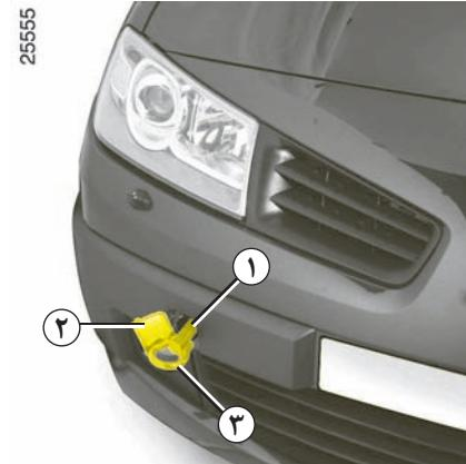
منحصراًً از قلاب بکسل جلو ۱ و عقب ۴ استفاده کنید (هیچ گاه از محور محرک (پلوس چرخ ها) استفاده نکنید). از این قلاب ها فقط باید برای یکدی کشیدن خودرو استفاده شود و هیچ گاه نباید از آنها به طور مستقیم یا غیر مستقیم جهت بلند کردن خودرو استفاده کرد.
