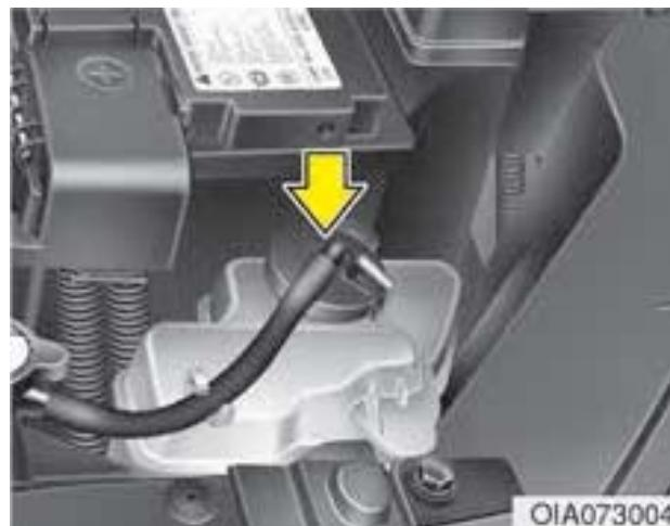
وضعیت و اتصال تمامی شیلنگ‌های سیستم خنک کننده و شیلنگ‌های بخاری را چک کنید. شیلنگ‌های آسیب دیده و باد کرده را تعویض کنید.
