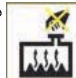
هرگز موقع کار کردن موتور و گرم بودن رادیاتور، در آن را باز نکنید. در غیر این صورت بخار و مایع خنک کننده داغ با فشار خارج شده و می تواند به شما آسیب برساند.
