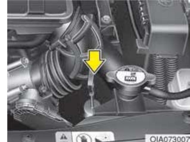
۳. مطمئن شوید که سطح روغن در سطح تراز روی HOT است. اگر سطح آن پایین‌تر بود، از طریق مجرای مخصوص روغن اضافه کنید. اگر بالاتر بود آن را از مجرای مخصوص خالی کنید.
