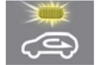
با انتخاب این وضعیت، هوای اتاقک سرنشین وارد سیستم گرمایشی شده و مطابق با وضعیت انتخاب شده آن را گرم یا سرد می کند.
