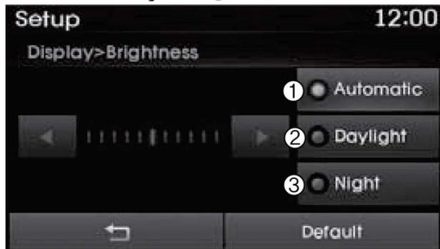
از کلید های **◀** , **▶** برای تنظیم شدت نور یا تنظیم شدت نور اتوماتیک، نور روز یا حالت شب استفاده کنید.
