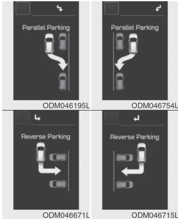
• با فشردن کلید سیستم کمکی پارک هوشمند در هنگامی که دنده خودرو در وضعیت رانندگی (D) است و پدال ترمز فشرده شده است، حالت پارک دوبل یا پارک معکوس را انتخاب کنید.
