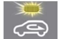
با انتخاب این وضعیت، هوای اتاقک سرنشین وارد سیستم گرمایشی شده و مطابق با وضعیت انتخاب شده آن را گرم یا سرد می کنند.
