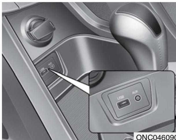
در صورتی که خودروی شما یک ورودی AUX و یا USB داشته باشد، می توانید از AUX برای اتصال دستگاهی صوتی و از USB برای اتصال یک USB و یا IPOD استفاده کنید.
