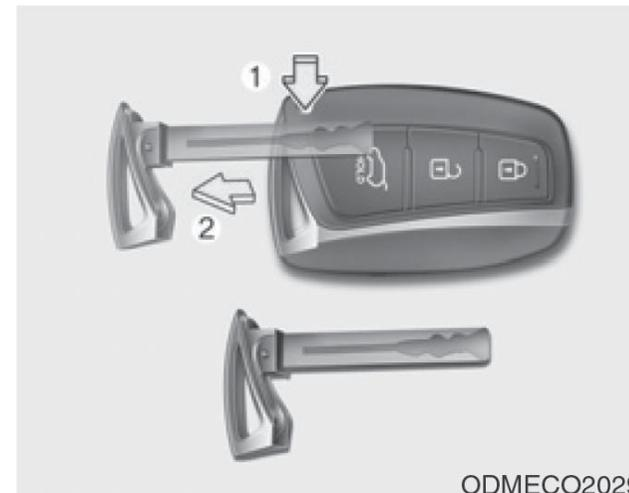
در صورتی که کلید هوشمند شما به صورت عادی کار نکند، می توانید قفل درب ها را با استفاده از کلید مکانیکی باز یا بسته کنید.
