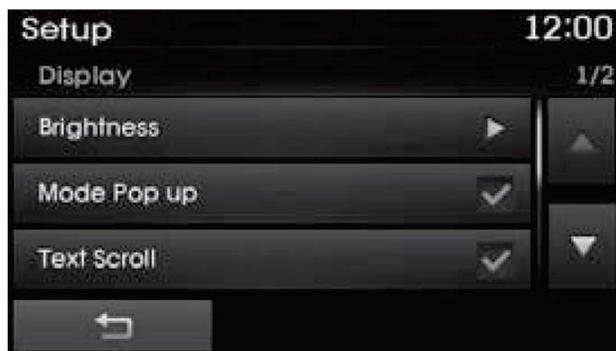
این ویژگی برای نمایش صفحه پاپ آپ در هنگام وارد شدن به حالت های مدیا و رادیو استفاده می شود.
