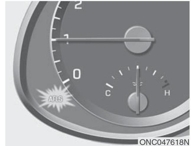
در صورت روشن بودن نمایشگر عیب AFSL، سیستم AFSL به صورت طبیعی قادر به کار نخواهد بود. به این ترتیب به نزدیکترین محل امن رانندگی کرده و موتور را خاموش و بعد روشن کنید. در صورت روشن ماندن چراغ اخطار، توصیه می‌کنیم به نمایندگی مجاز شرکت کرمان موتور مراجعه کنید.
