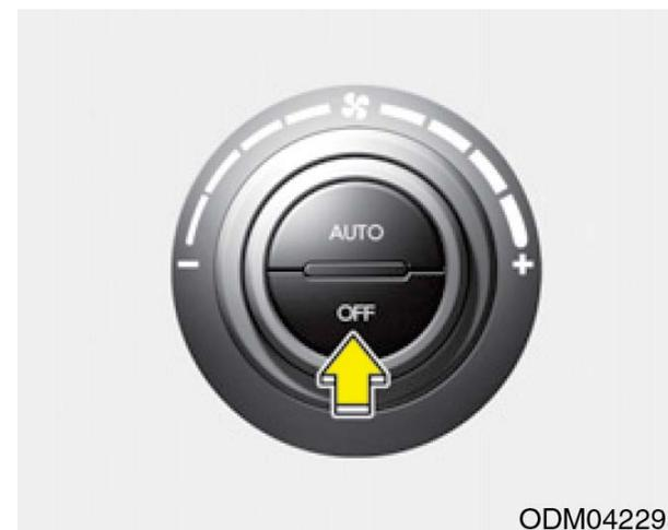
کلید OFF فن جلو را فشار دهید تا سیستم کنترل دمای هوای جلو را خاموش کنید. با این وجود همچنان قادر خواهید بود تا زمانی که سوئیچ خودرو در وضعیت ON است با حالت و کلیدهای هوای ورودی، کار کنید.
