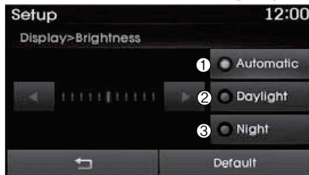
از کلیدهای **◀**, **▶** برای تنظیم شفافیت صفحه نمایش یا تنظیم روشنایی به صورت خودکار، حالت روز یا شب، استفاده کنید. برای بازیابی تنظیمات پیش فرض کلید **Default** را فشار دهید.
