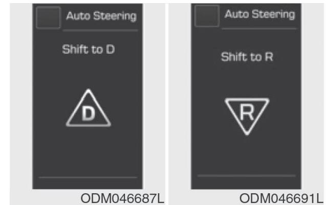
تعویض دنده خودرو در حین کنترل فرمان در صورت رویت پیغام نمایش داده شده در بالا به همراه صدای "بیپ" دنده را عوض کرده و با فشردن پدال ترمز به رانندگی ادامه دهید.
