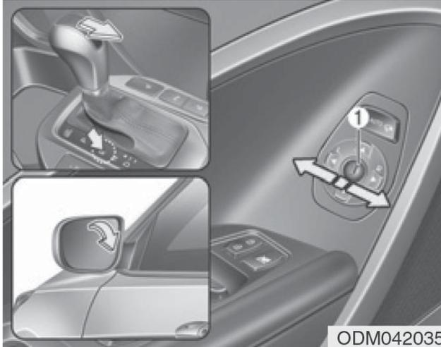
هنگامی که دنده خودرو را به وضعیت R (دنده عقب) می برید، آینه های بغل به سمت پایین حرکت می کنند تا در فرایند پارک به شما کمک کنند. بسته به وضعیت کلید کنترل آینه بغل (۱)، آینه های بغل به ترتیب زیر عمل خواهند کرد:
