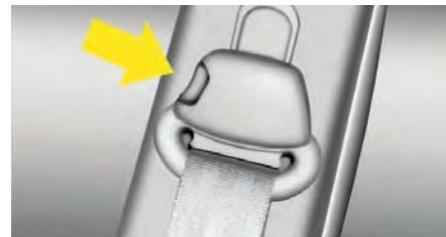
ارتفاع کمربند ایمنی صندلی جلو را می‌توانید با استفاده از پایه نگهدارنده تنظیم کنید. کمربند ایمنی باید از روی شکم، سینه و شانه‌ها عبور کند و نه از روی گردن. کمربند ایمنی که خیلی نزدیک به گردن قرار گیرد، نمی‌تواند حفاظت کامل را فراهم آورد.
