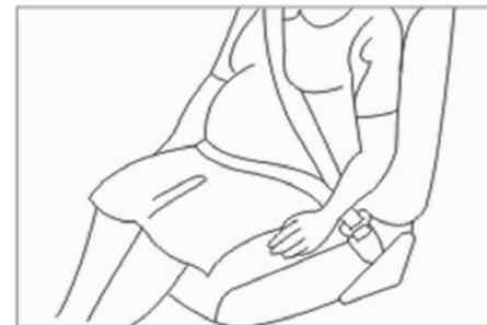
زنان باردار برای سواری در خودرو باید توصیه‌های پزشک خود را دنبال نمایید. بهتر است زنان باردار از کمربند ایمنی سه نقطه‌ای استفاده کنند. بخش روی پای کمربند ایمنی باید تا آنجا که ممکن است شل، راحت و پایین قرار گیرد.
