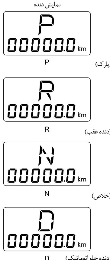
صفحه نمایش سیستم انتقال قدرت اتوماتیک دندوهای سیستم انتقال قدرت اتوماتیک در قسمت A صفحه نمایش جلو آمپر نشان داده خواهد شد و حالت عملیاتی سیستم انتقال قدرت اتوماتیک در قسمت بالای محل نمایش دنده نشان داده خواهد شد.
