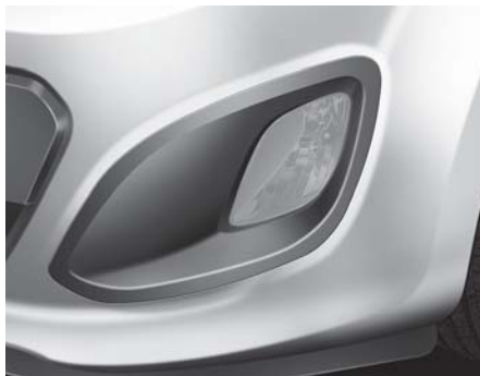
لامپ چراغ مه شکن جلو یا DRL یا لامپ چراغ مه شکن جلو + DRL (در صورت مجهز بودن)
