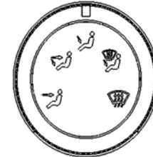
(کلید کنترل مسیر توزیع هوا)
