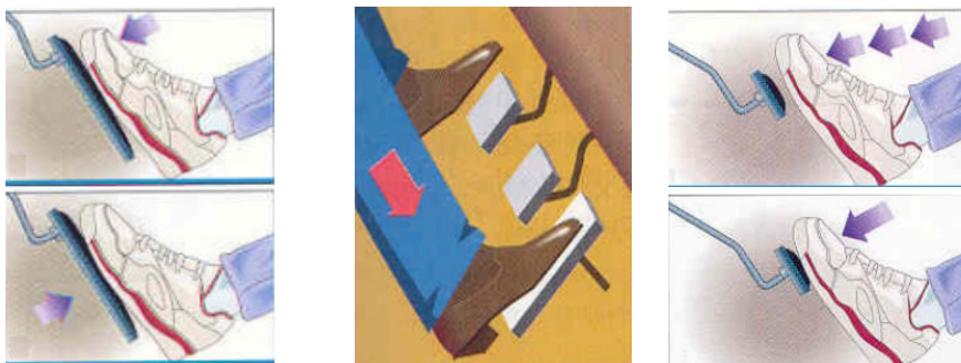
پدالهای گاز، ترمز و کلاچ و نحوه اعمال نیرو بر آنها
